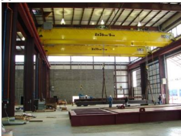
Slika 8. Bridge crane mosni granik s dva mosta (kutijasti profil) [3]
