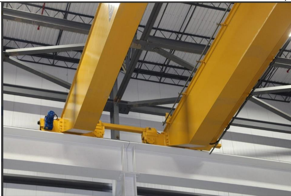
Slika 12. Most s većim brojem kotača [1]
