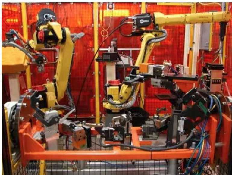
Slika 29. Radna stanica za elektrootporno točkasto i MAG zavarivanje [15]
