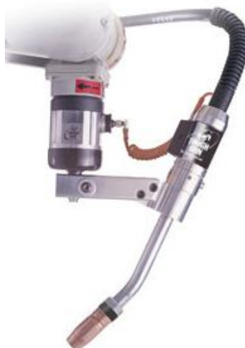
Slika 62. Senzor protiv kolizije spojen na šestu os robota [31]
