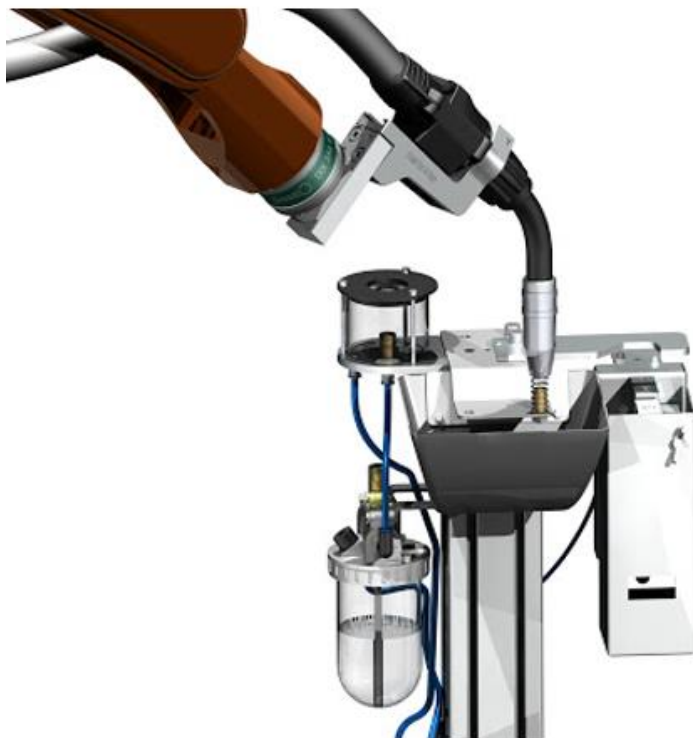
Slika 60. Stanica za čišćenje pištolja [30]
