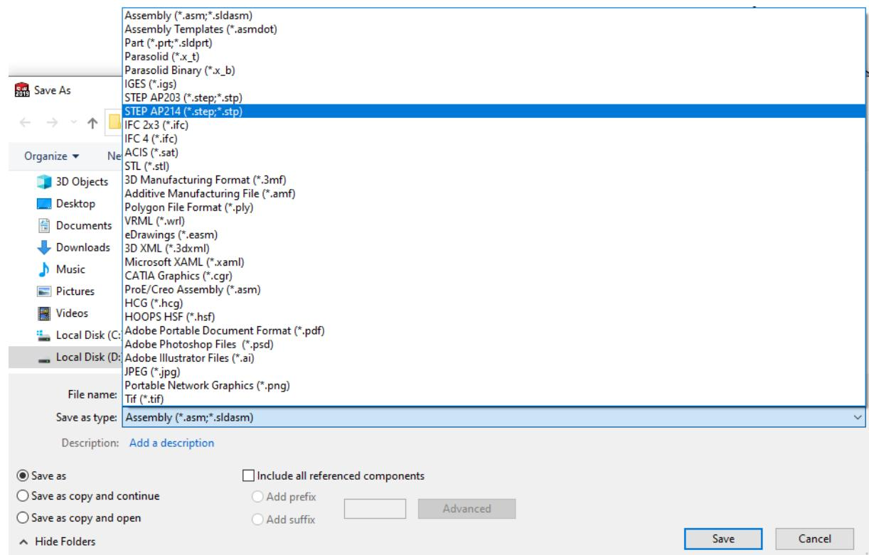
Slika 27. Pretvorba .SLDASM formata u .STEP format
