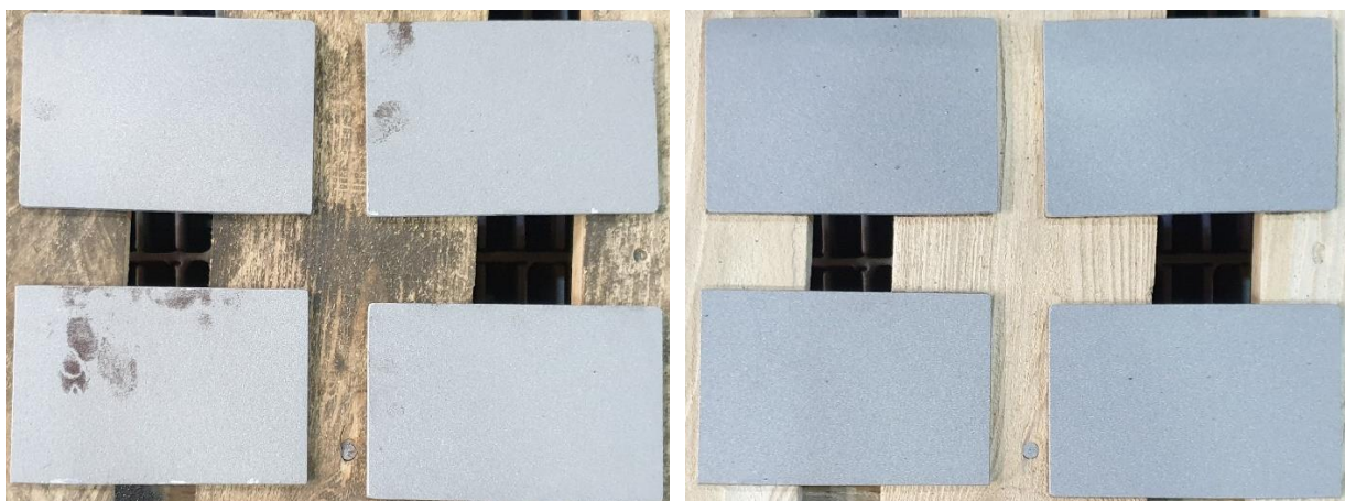
Slika 29. Ispitni uzorci prije (lijevo) i poslije (desno) sačmarenja
