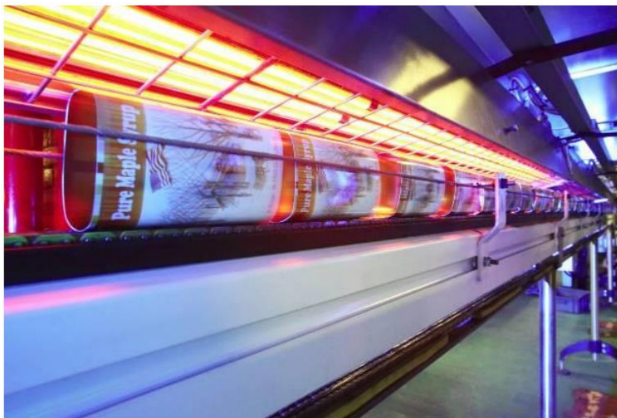
Slika 22. Otvrdnjavanje boje na posudama IC ugljičnim lampama [22]
