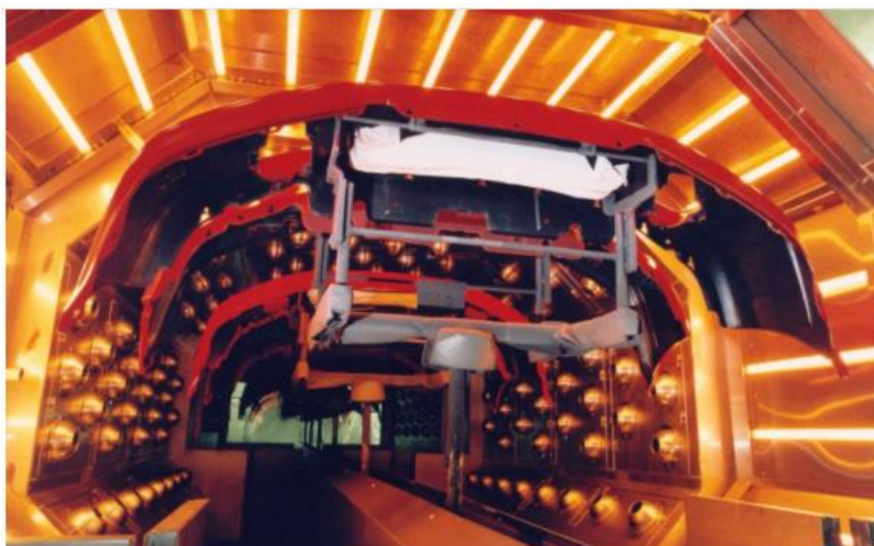
Slika 24. IC kabina za sušenje premaza nanesenih na branike automobila [24]
