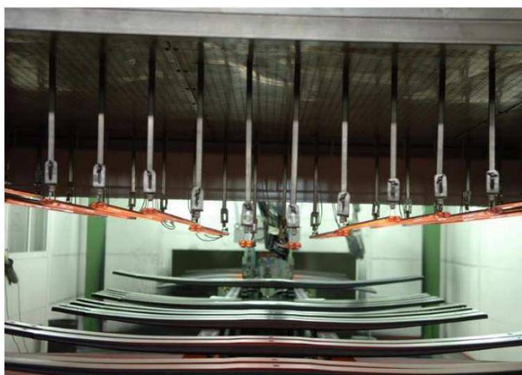
Slika 23. IC kabina za sušenje lisnatih zavojnih opruga [23]
