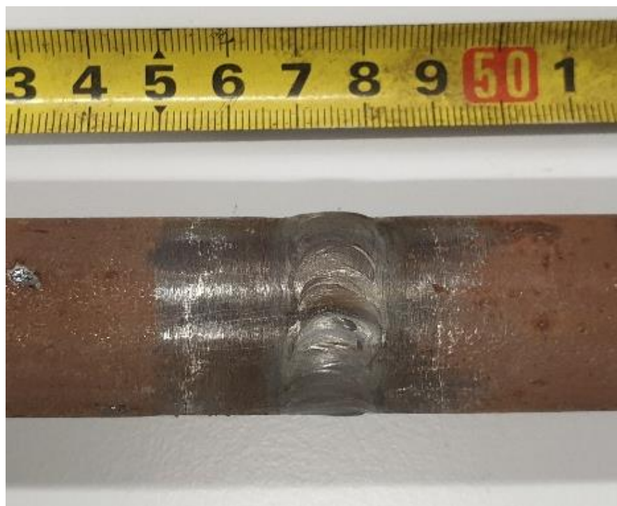
Slika 28. Zavareni sučeljeni spoj
