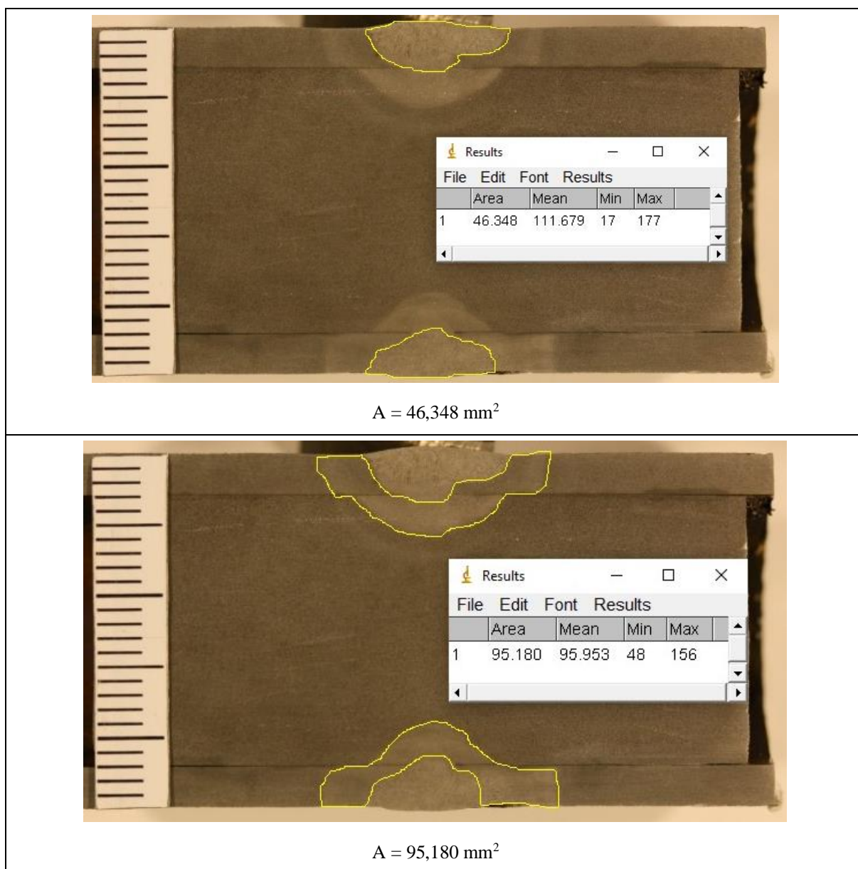
Tablica 26. Mjerenje površina na sučeljenom spoju
