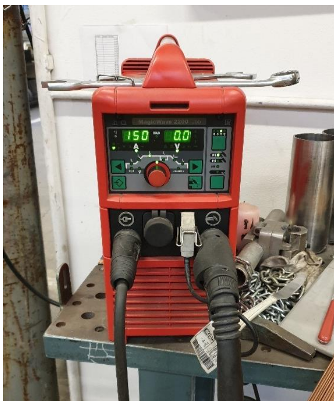
Slika 21. Izvor struje za zavarivanje MagicWave 2200
