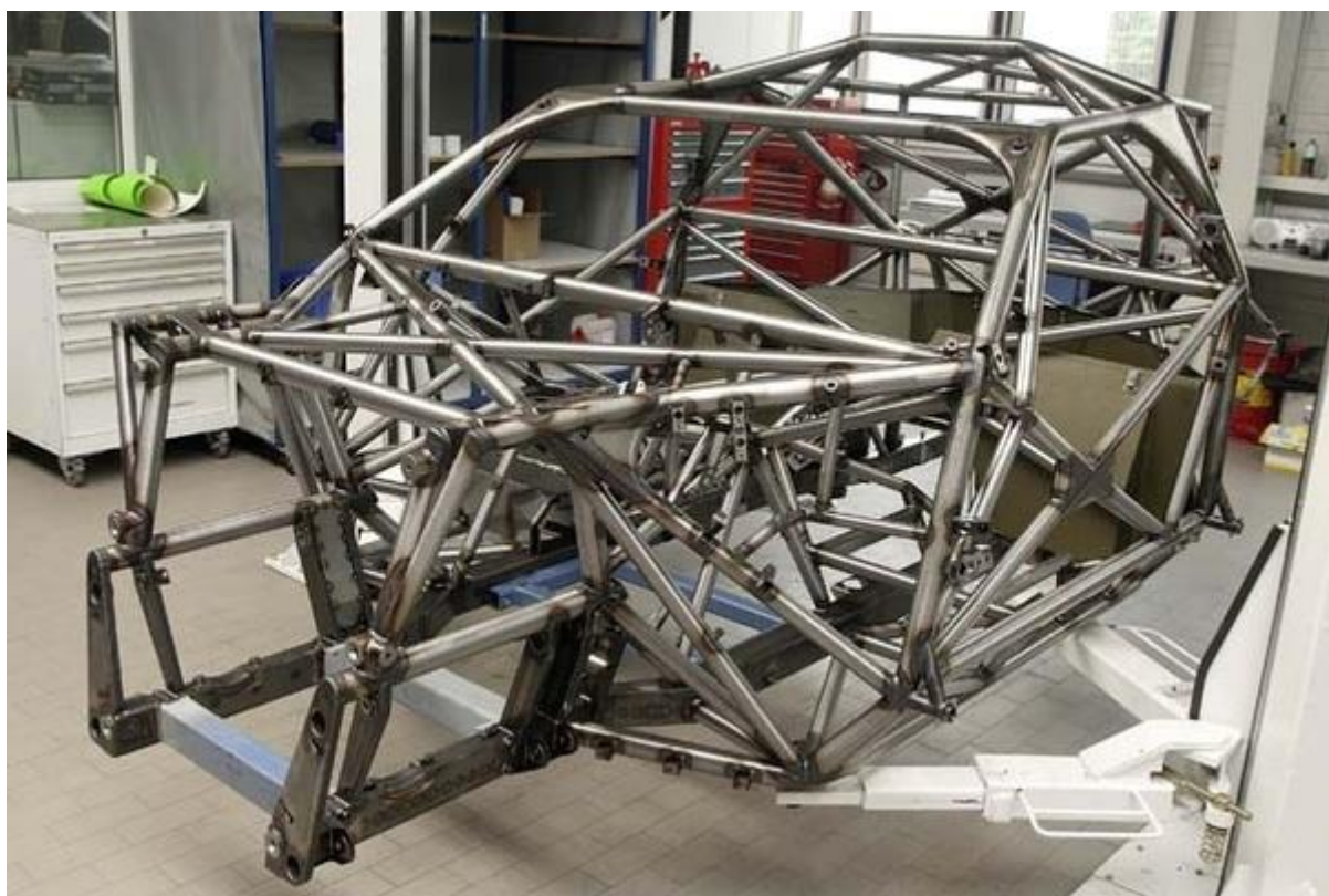
Slika 3. Karoserija izrađena od cijevi [4]
