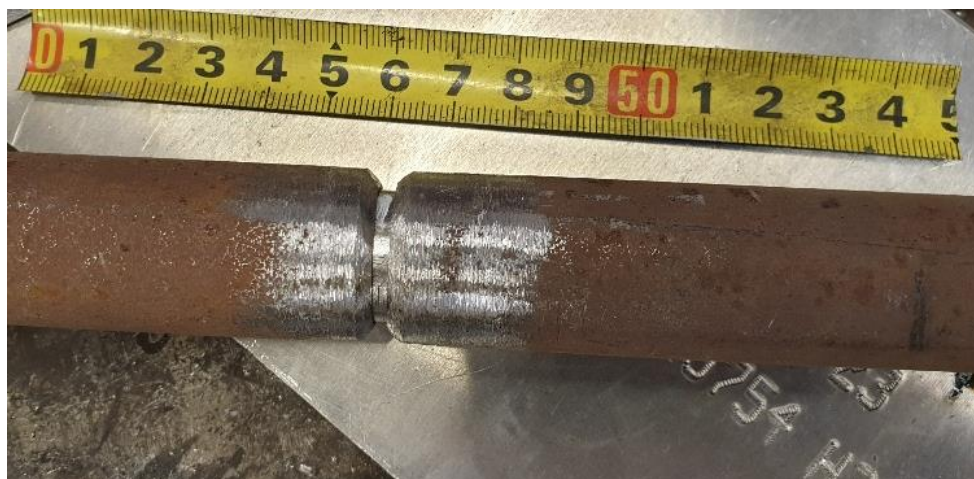
Slika 26. Pripremljene cijevi za zavarivanje čeonog spoja
