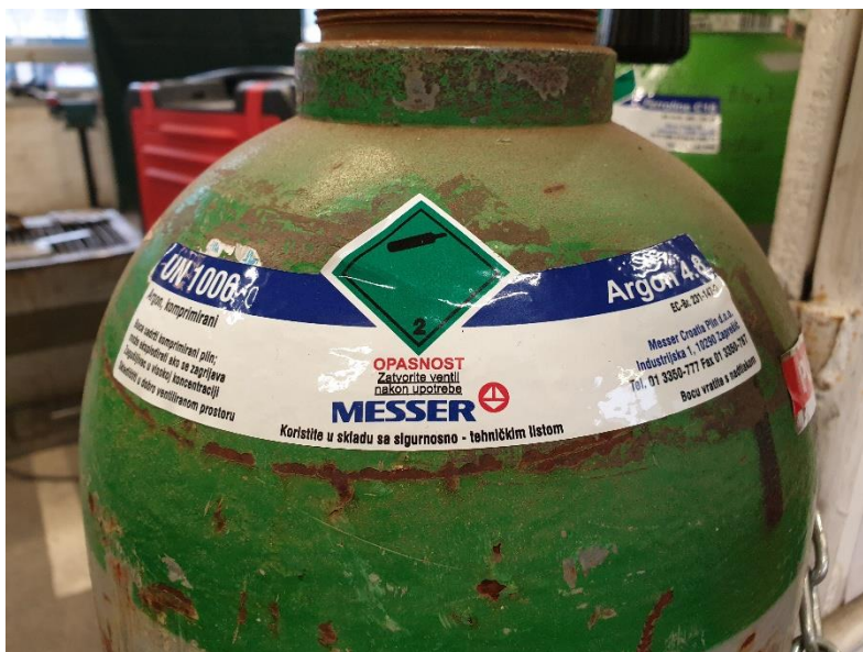
Slika 22. Boca sa zaštitnim plinom (Argon 4.8)
