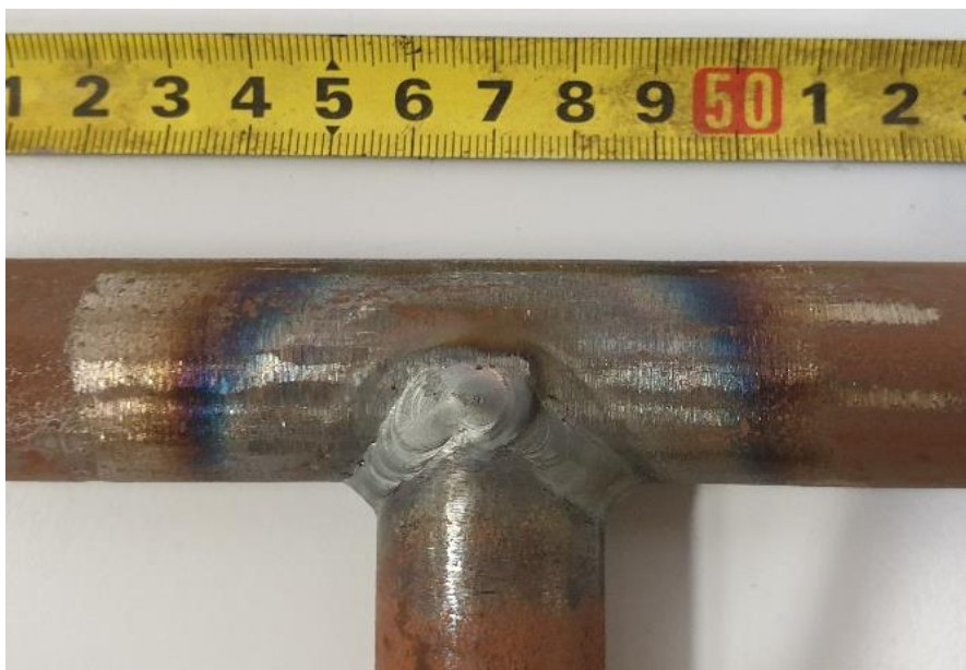
Slika 27. Zavareni kutni spoj
