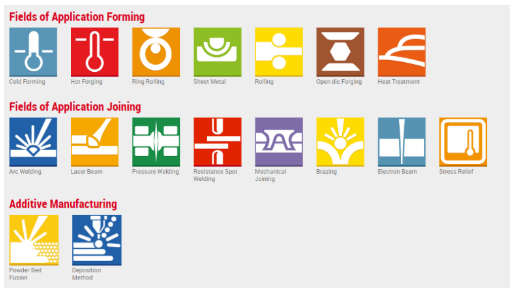
Slika 18. Prikaz postupaka koji se mogu simulirati koristeći Simufact [20]
