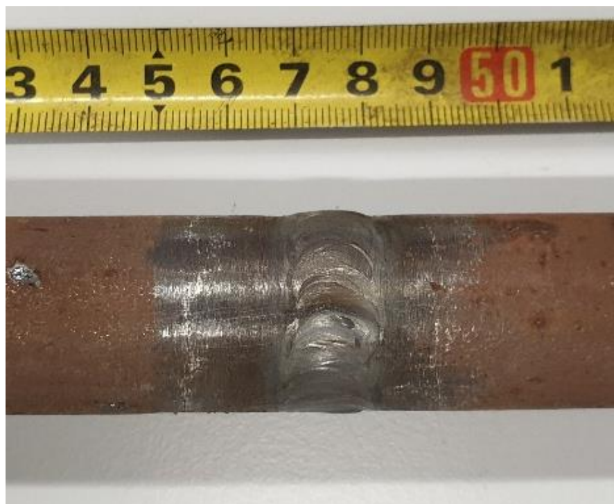
Slika 28. Zavareni sučeljeni spoj
