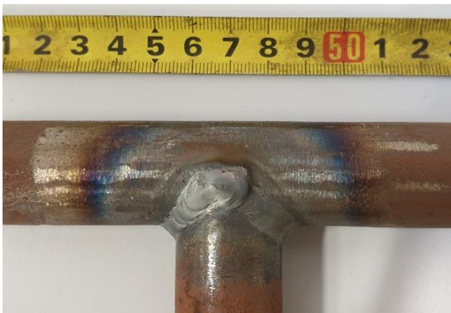
Slika 27. Zavareni kutni spoj
