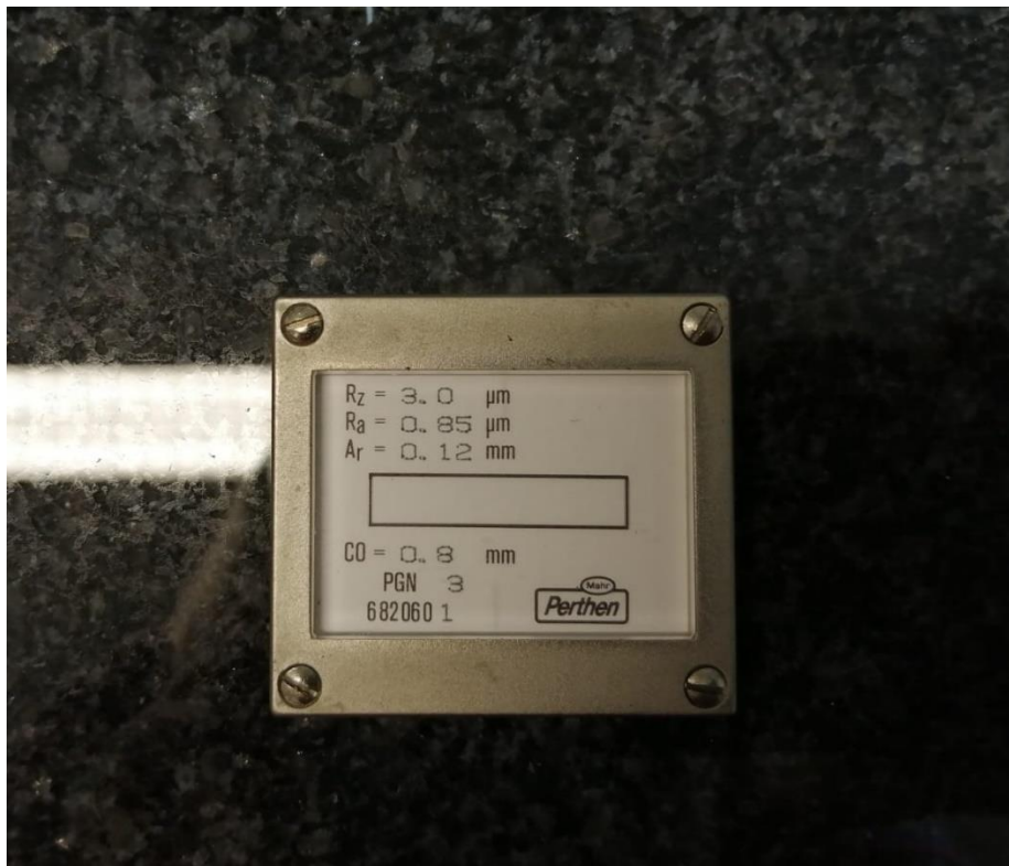
Slika 20. Etalon s regularnom trokutastom geometrijom
