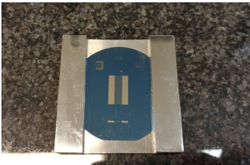
Slika 21. Etalon s regularnom pravokutnom geometrijom
