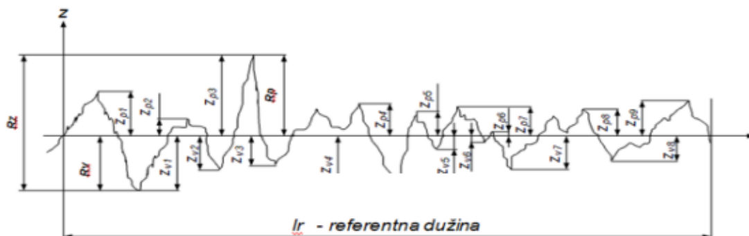
Slika 6. R_p , R_v i R_z parametri [1]
