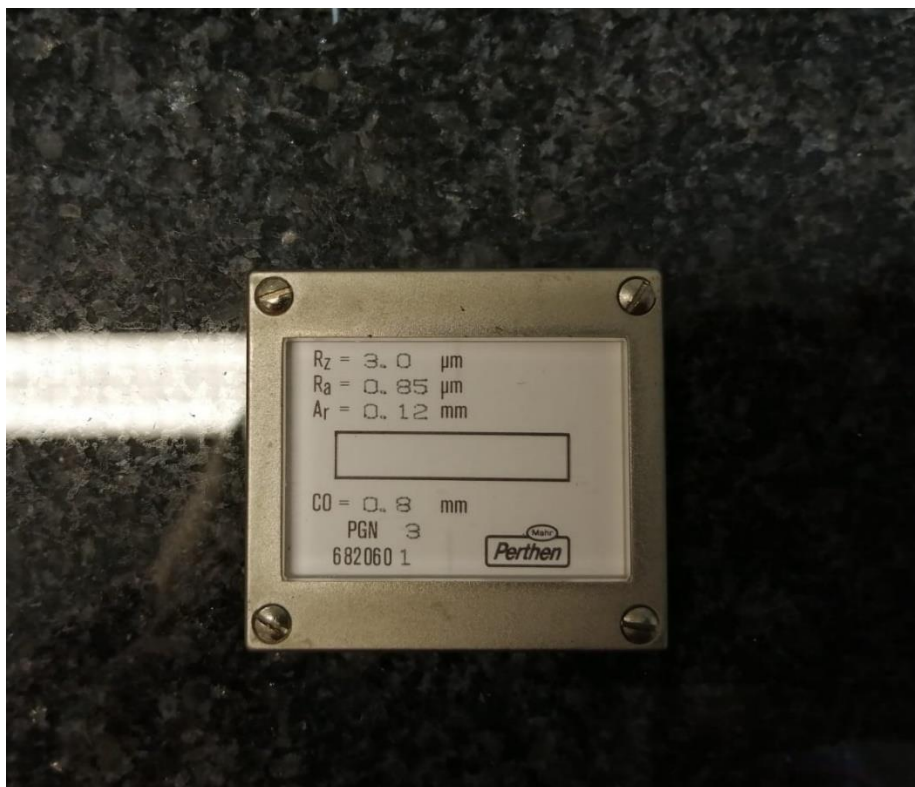
Slika 20. Etalon s regularnom trokutastom geometrijom
