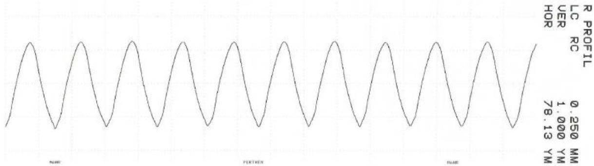
Slika 28. Prikaz trokutastog profila dobivenog filtracijom RC filterom s  $\lambda c = 2,5$  mm,
