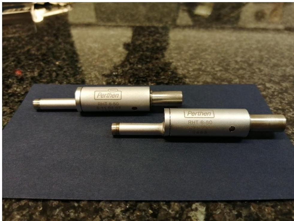
Slika 23. Mjerna ticala polumjera 2  $\mu\text{m}$  i 5  $\mu\text{m}$
