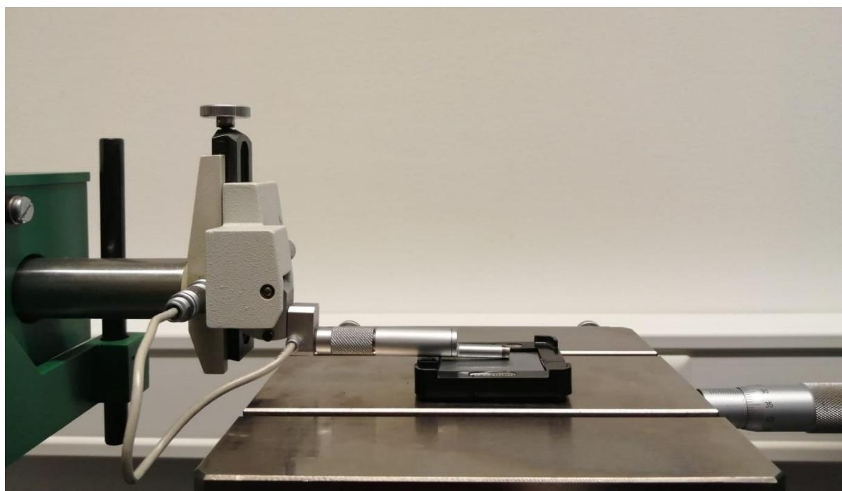
Slika 25. Mjerenje etalona iregularne geometrije ticalom polumjera  $5 \mu\text{m}$
