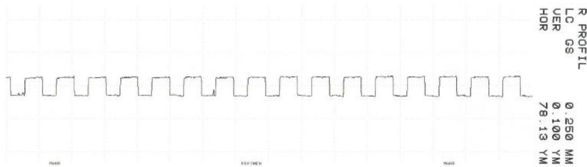
Slika 38. Prikaz pravokutnog profila dobivenog filtracijom Gauss filterom s  $\lambda c = 0,25 \text{ mm}$ , (polumjer ticala 5  $\mu\text{m}$ )
