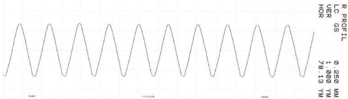
Slika 26. Prikaz trokutastog profila dobivenog filtracijom Gauss filterom s  $\lambda c = 0,25$  mm,
