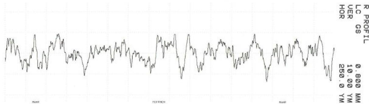
Slika 42. Prikaz iregularnog profila dobivenog filtracijom Gauss filterom s  $\lambda_c = 0,8 \text{ mm}$ ,
