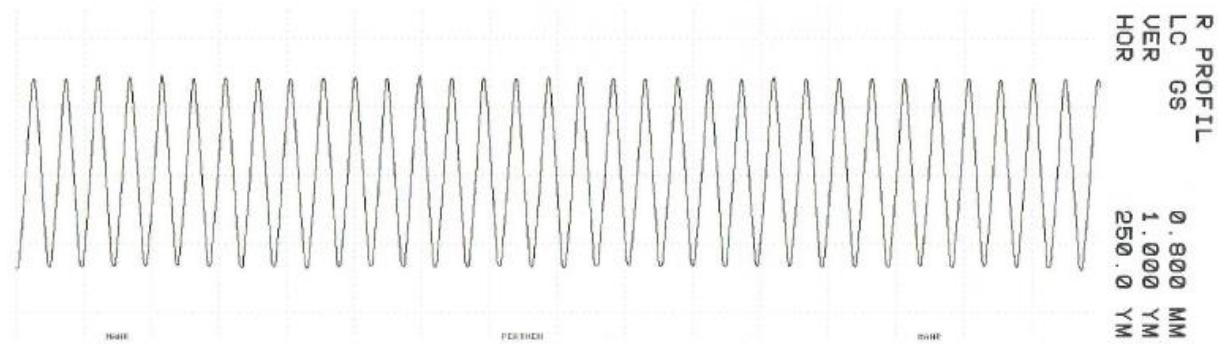
Slika 27. Prikaz trokutastog profila dobivenog filtracijom Gauss filterom s  $\lambda c = 0,8$  mm,
