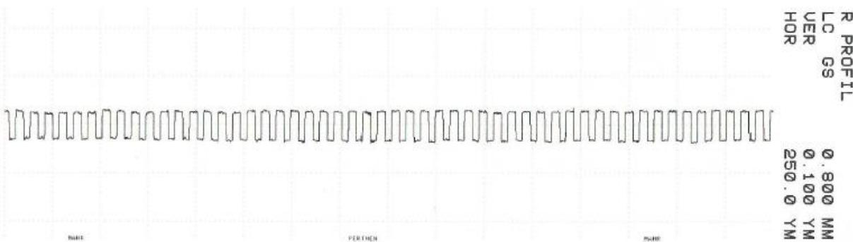
Slika 39. Prikaz pravokutnog profila dobivenog Gauss filterom s  $\lambda c = 0,8 \text{ mm}$ , (polumjer ticala 5  $\mu\text{m}$ )
