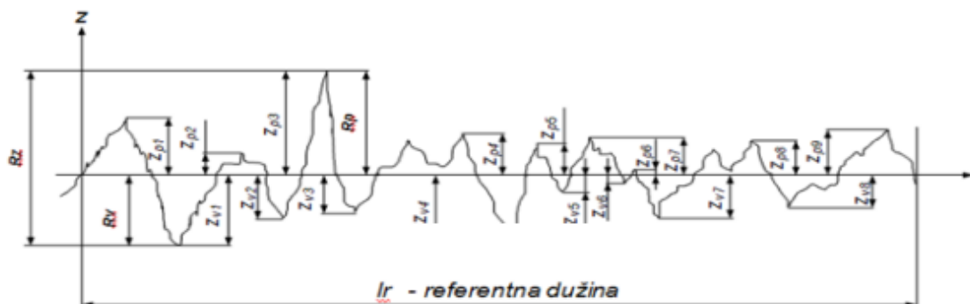
Slika 6. R_p , R_v i R_z parametri [1]
