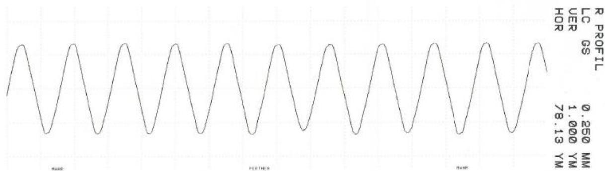
Slika 35. Prikaz trokutastog profila dobivenog filtracijom Gauss filterom s  $\lambda c = 0,25 \text{ mm}$ , (polujer ticala 5 μm)
