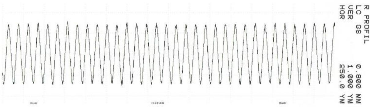
Slika 45. Prikaz trokutastog profila dobivenog filtracijom Gauss filterom s  $\lambda c = 0,8$  mm,
