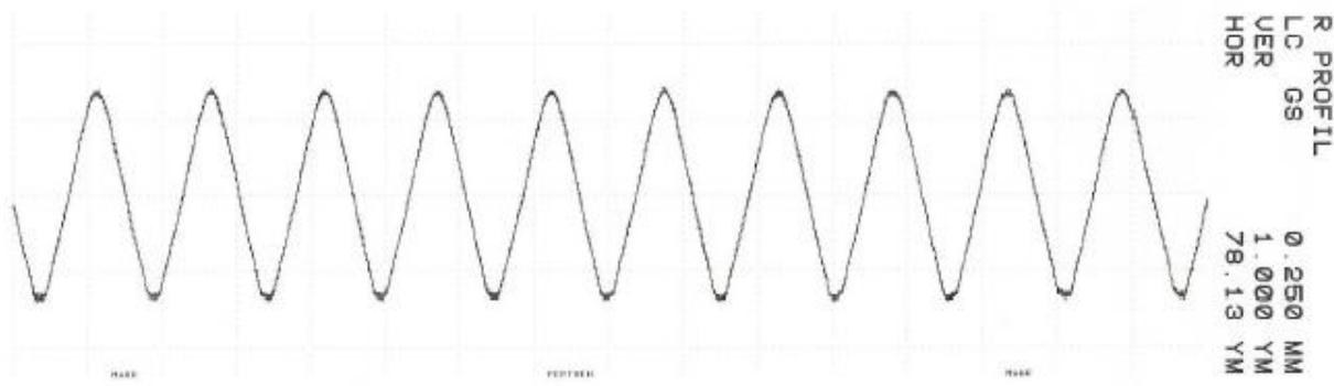
Slika 44. Prikaz trokutastog profila dobivenog filtracijom Gauss filterom s  $\lambda c = 0,25$  mm,
