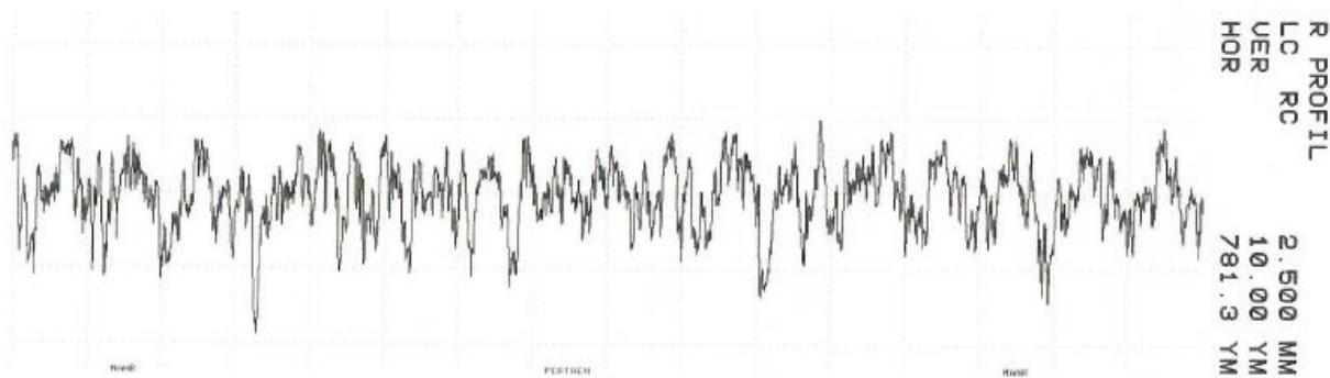
Slika 52. Prikaz iregularnog profila dobivenog filtracijom RC filterom s  $\lambda c = 2,5$  mm,
