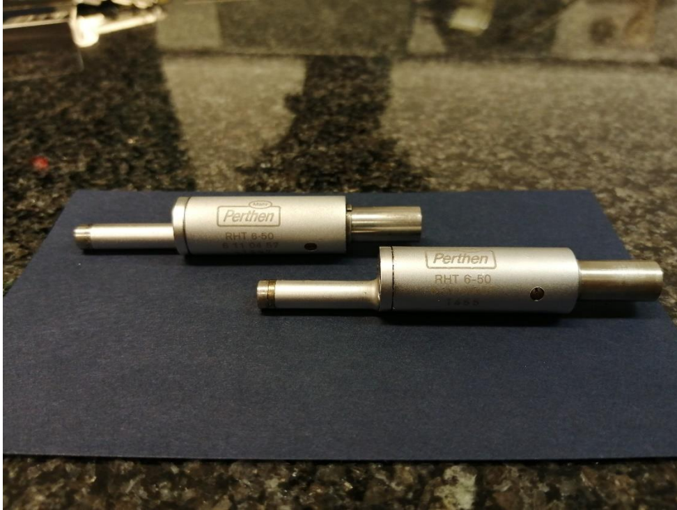
Slika 23. Mjerna ticala polumjera 2 \mu\text{m} i 5 \mu\text{m}
