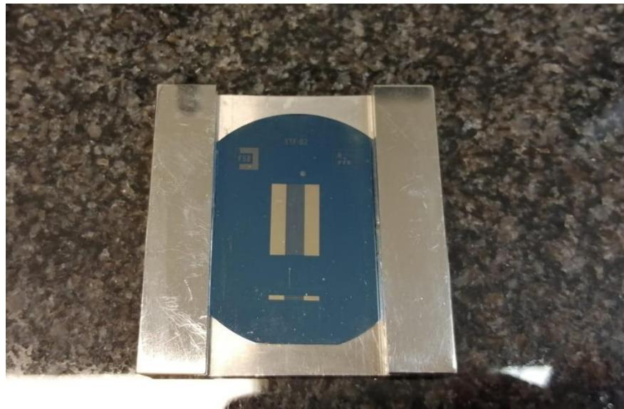
Slika 21. Etalon s regularnom pravokutnom geometrijom
