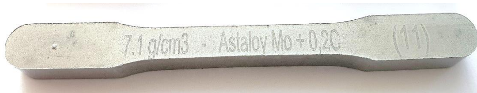
Slika 19. Prikaz epruvete načinjene od Astaloy Mo-0,2C
