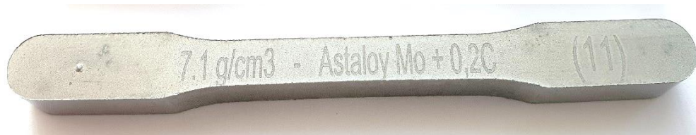
Slika 19. Prikaz epruvete načinjene od Astaloy Mo-0,2C
