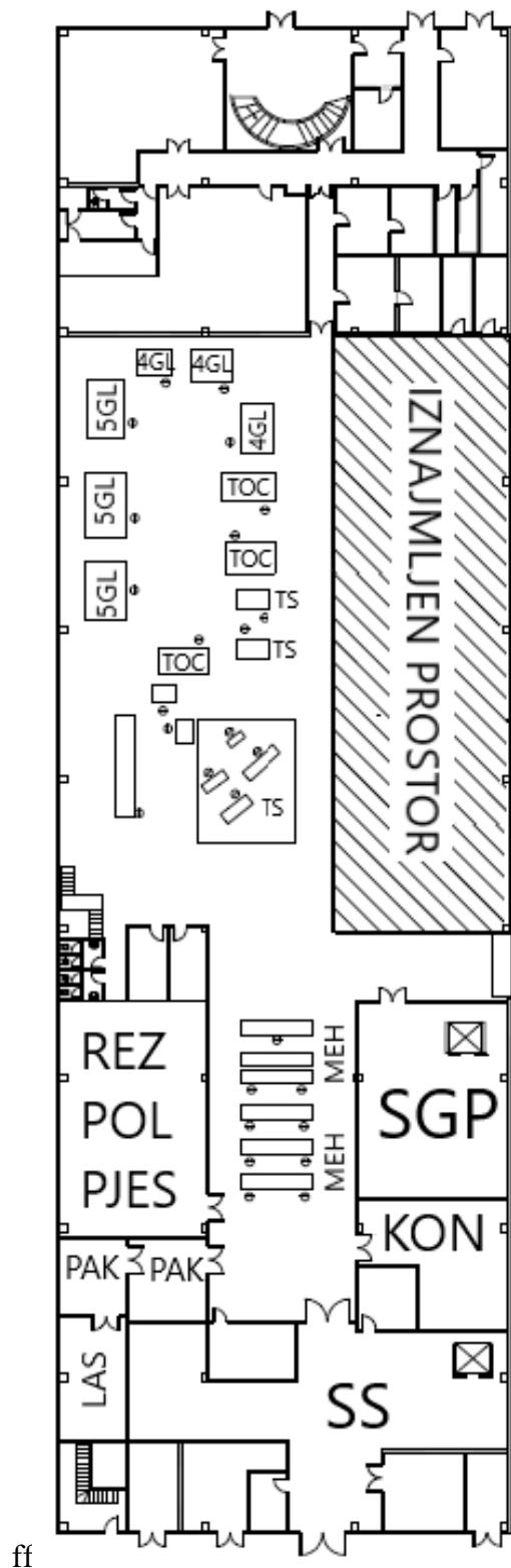
Slika 26. Tlocrt proizvodnog sustava - glavna hala
