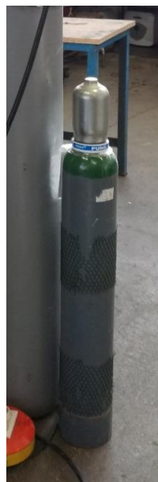
Slika 42. Boca zaštitnog plina Aluline He15
