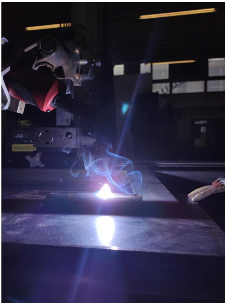
Slika 43. Postupak protaljivanja uzorka od čelika P91 pod zaštitom 100 % Ar
