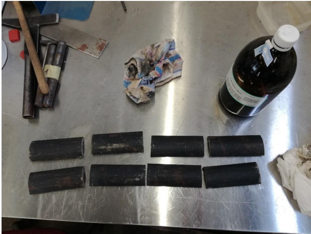
Slika 40. Pripremljeni očišćeni uzorci prije protaljivanja
