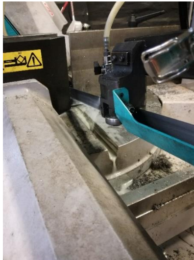
Slika 47. Izrezivanje makroizbrusaka pomoću tračne pile
