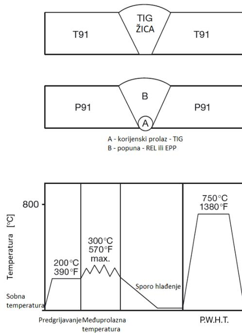
Slika 26. Zavarivanje čelika T/P91 sa čelikom T/P91 [4]
