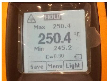
**Slika 38. Izmjerena temperatura na termometru Fluke 568 neposredno prije protaljivanja**
