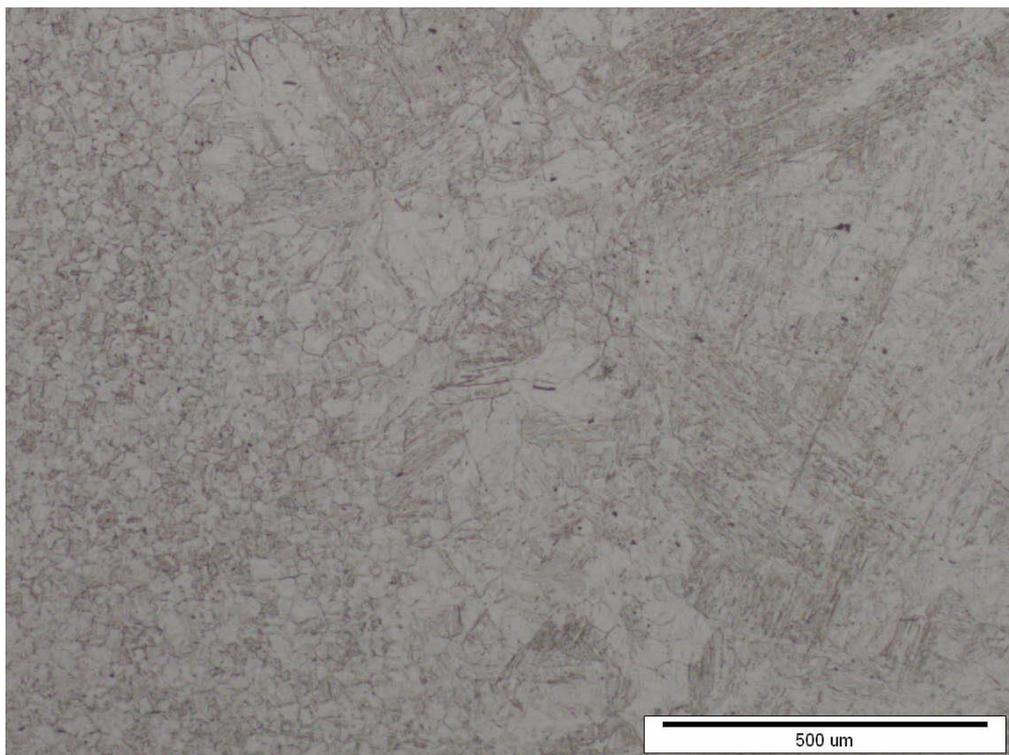
**Slika 65. Mikrostruktura karakterističnih dijelova uzorka 4, povećanje 500x**
