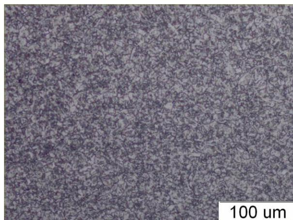
**Slika 60. Mikrostruktura osnovnog materijala (čelik P91), povećanje 100x**
