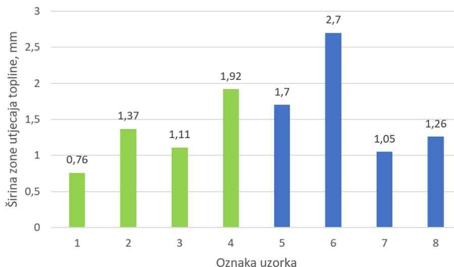
**Slika 59. Usporedba širina zone utjecaja topline za svaki uzorak pojedinačno (zelenom bojom označeni su uzorci protaljivani pod zaštitom 100 % Ar, a plavom bojom uzorci protaljivani pod zaštitom 85 % Ar / 15 % He)**
