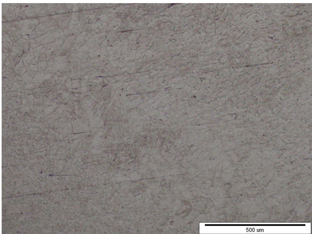
**Slika 66. Mikrostruktura karakterističnih dijelova uzorka 5, povećanje 500x**
