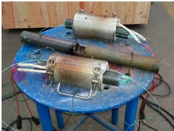
Slika 24. Postavka prilikom predgrijavanja cijevi od čelika [12]
