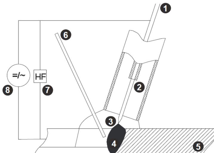
**Slika 31. Shematski prikaz TIG postupka zavarivanja: 1 – netaljiva elektroda; 2 – sapnica gorionika; 3 – električni luk; 4 – rastaljeni materijal; 5 – metal zavara; 6 – dodatni materijal; 7 – visokofrekventni generator; 8 – izvor struje [16]**
