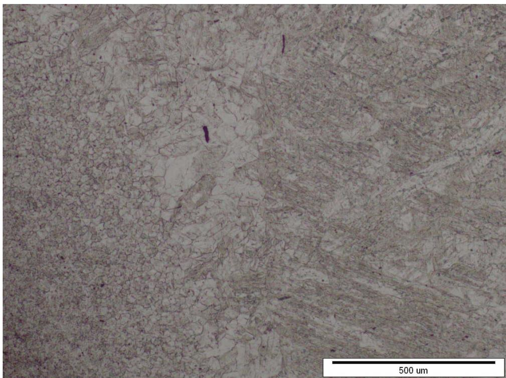
**Slika 68.** Mikrostruktura karakterističnih dijelova uzorka 7, povećanje 500x
