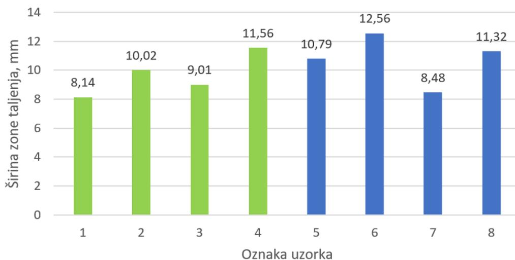
**Slika 57. Usporedba širina zone taljenja za svaki uzorak pojedinačno (zelenom bojom označeni su uzorci protaljivani pod zaštitom 100 % Ar, a plavom bojom uzorci protaljivani pod zaštitom 85 % Ar / 15 % He)**
