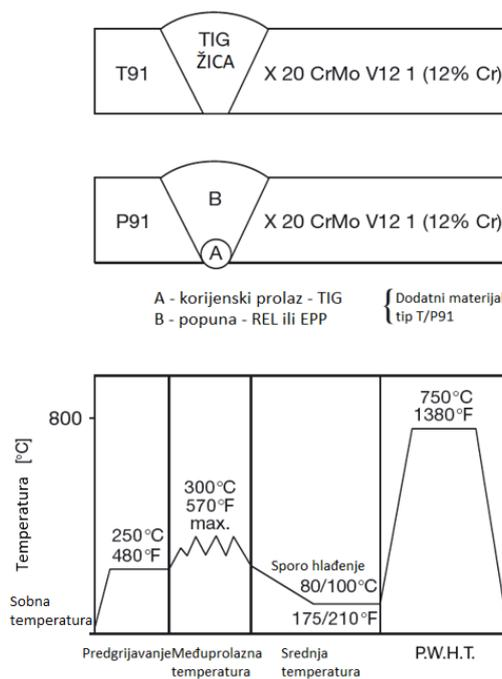
Slika 27. Zavarivanje čelika T/P91 s 12 % Cr materijalima [4]
