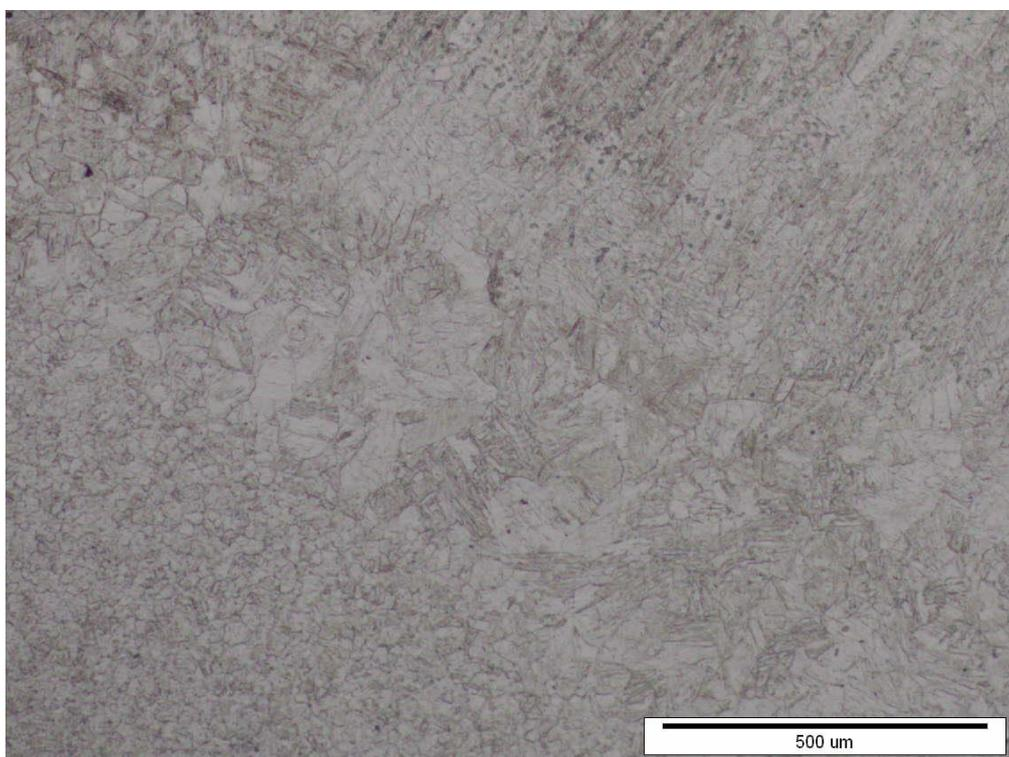
**Slika 64.** Mikrostruktura karakterističnih dijelova uzorka 3, povećanje 500x
