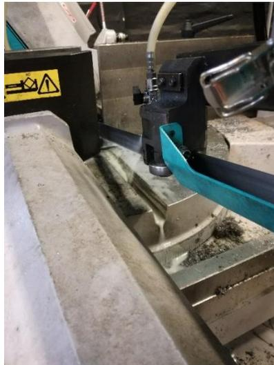
**Slika 47. Izrezivanje makroizbrusaka pomoću tračne pile**
