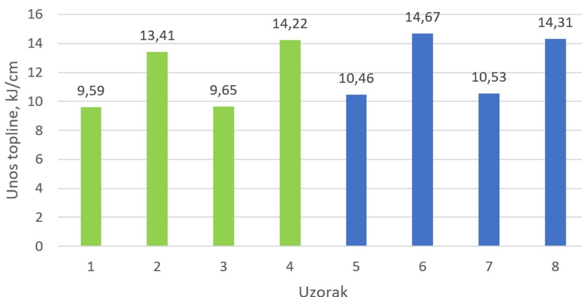
**Slika 46. Usporedba toplina unesenih prilikom protaljivanja za svaki uzorak pojedinačno (zelenom bojom označeni su uzorci protaljivani pod zaštitom 100 % Ar, a plavom bojom uzorci protaljivani pod zaštitom 85 % Ar / 15 % He)**
