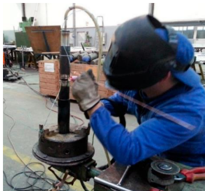
Slika 25. Zavarivanje cijevi od čelika P91 [12]
