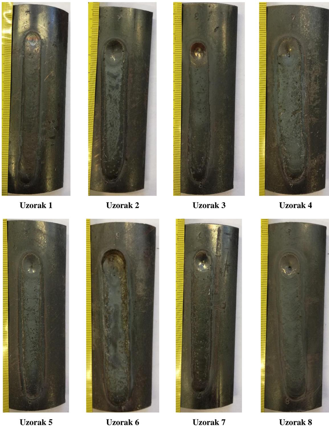
**Slika 45. Uzorci nakon postupka protaljivanja**
