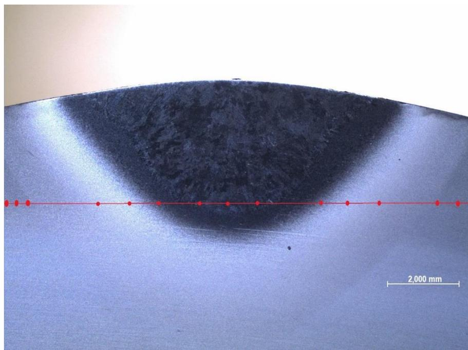
**Slika 71. Makroizbrusak uzorka 1 s označenim točkama mjerenja tvrdoće**
