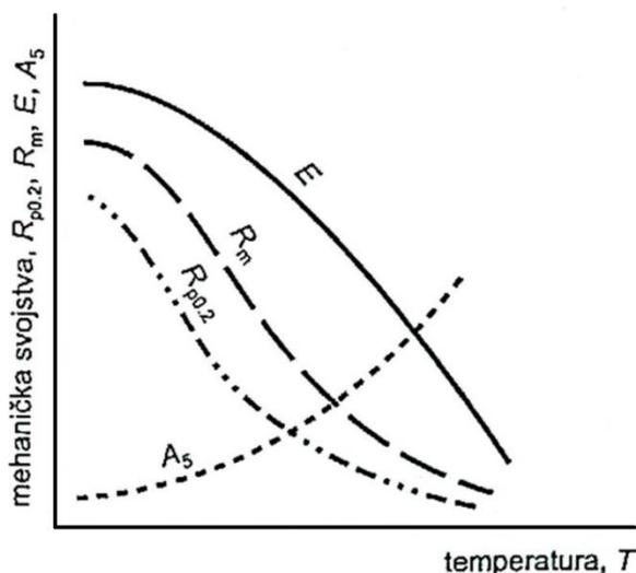
**Slika 3.** Promjena mehaničkih svojstava uz povišenje temperature [2]
