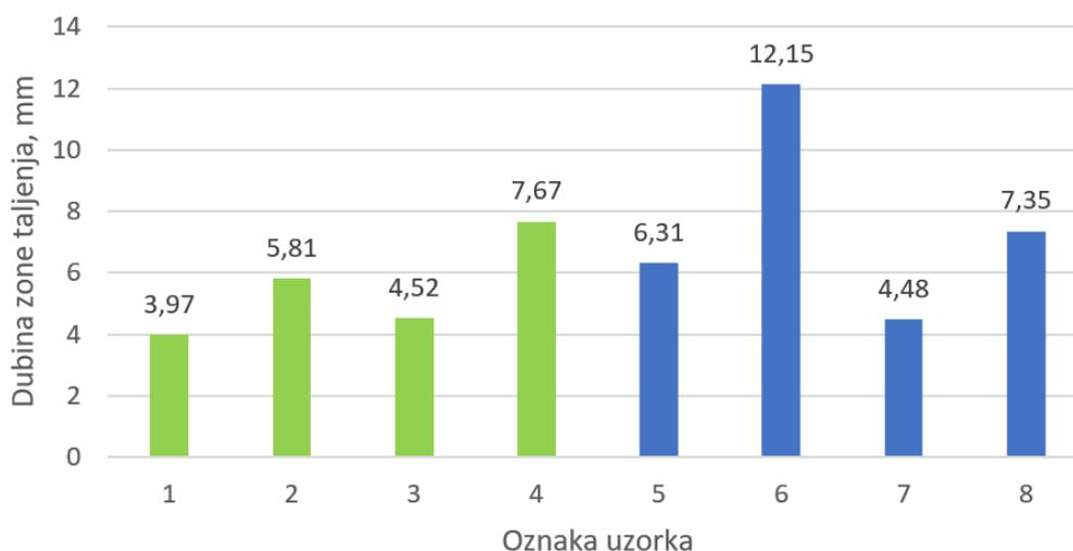
**Slika 58. Usporedba dubina zone taljenja za svaki uzorak pojedinačno (zelenom bojom označeni su uzorci protaljavani pod zaštitom 100 % Ar, a plavom bojom uzorci protaljavani pod zaštitom 85 % Ar / 15 % He)**
