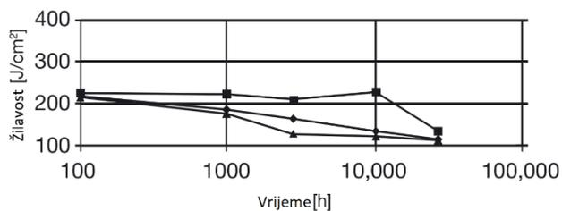
Slika 19. Žilavost čelika P91 nakon dozrijevanja [4]
