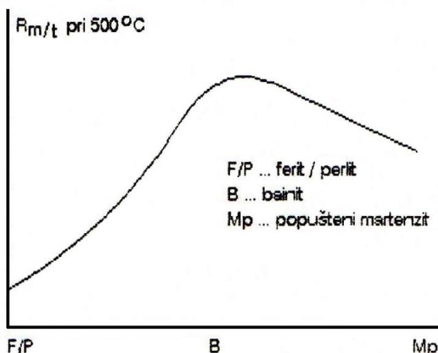
Slika 6. Utjecaj mikrostrukture na statičku izdržljivost pri 500 °C [1]
