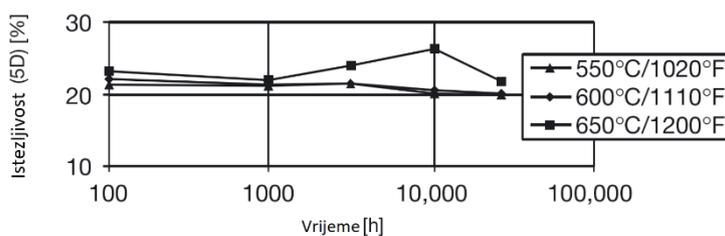
Slika 20. Istezljivost čelika P91 nakon dozrijevanja [4]
