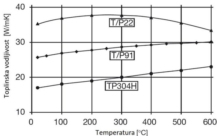
Slika 8. Ovisnost toplinske vodljivosti i temperature [4]
