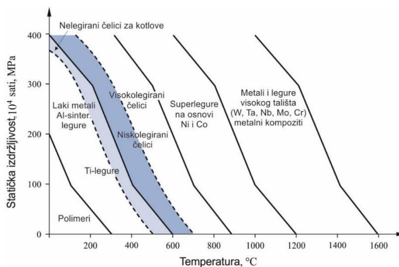
Slika 7. Ovisnost statičke izdržljivosti o temperaturi [1]
