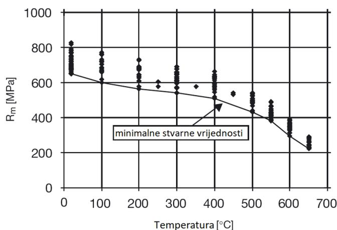
**Slika 12.** Vrijednosti vlačne čvrstoće za čelik P91 u odnosu na povišenje temperature [4]
