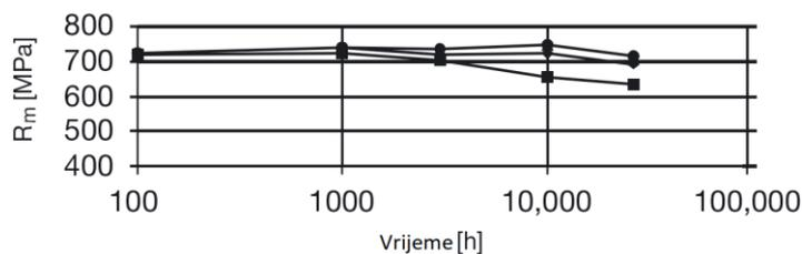
Slika 18. Vlačna čvrstoća čelika P91 nakon dozrijevanja [4]
