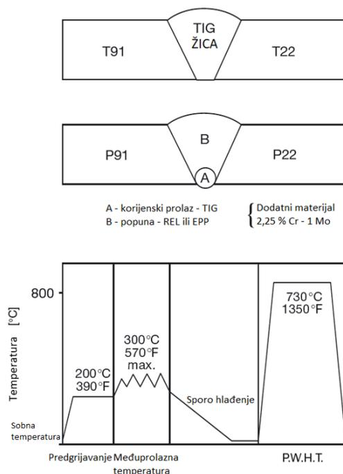
Slika 28. Zavarivanje čelika T/P91 sa T/P22 [4]
