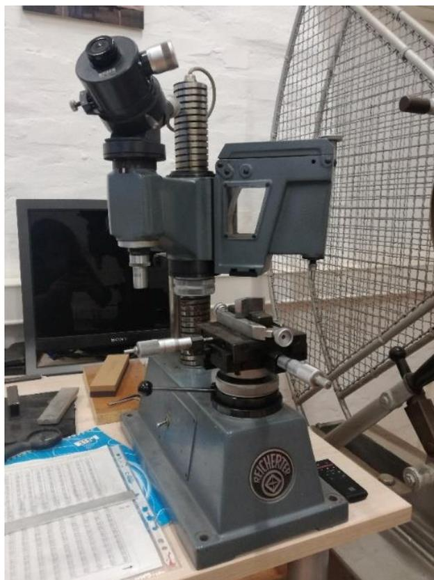
Slika 70. Uređaj za mjerenje tvrdoće Reichert
