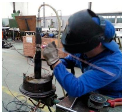
Slika 25. Zavarivanje cijevi od čelika P91 [12]
