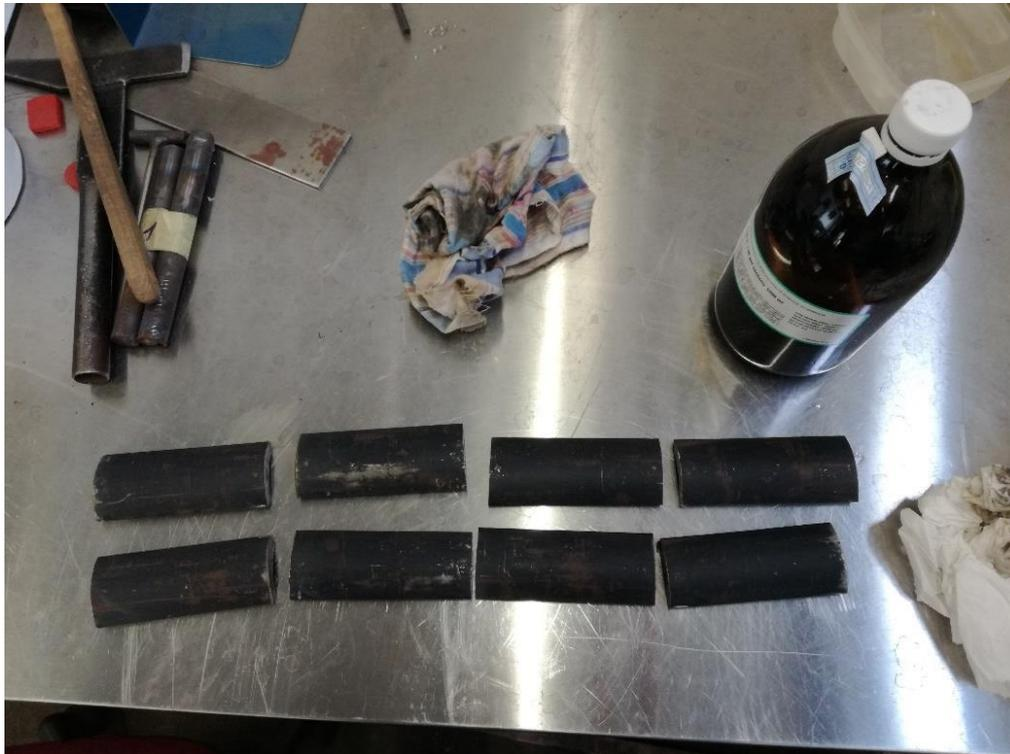
**Slika 40. Pripremljeni očišćeni uzorci prije protaljivanja**
