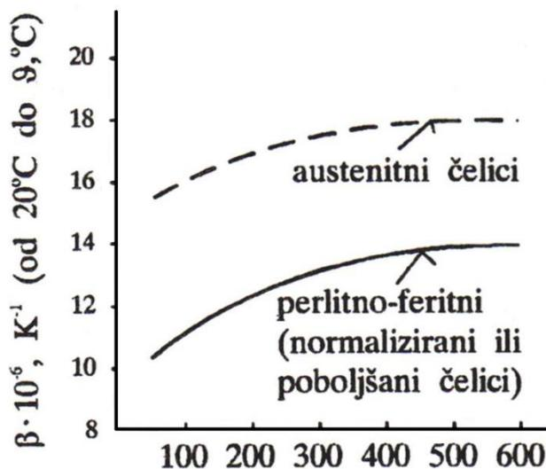
**Slika 2.** Ovisnost koeficijenta toplinskog istezanja čelika o temperaturi [1]
