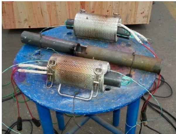
Slika 24. Postavka prilikom predgrijavanja cijevi od čelika [12]
