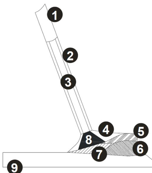
**Slika 29. Shematski prikaz REL zavarivanja: 1 – obložena elektroda; 2 – obloga; 3 – žica; 4 – zaštitni plinovi; 5 – troska; 6 – metal zavara; 7 – rastaljeni materijal; 8 – električni luk; 9 – osnovni materijal [15]**
