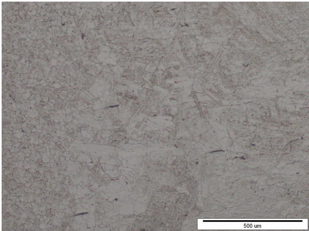
**Slika 67.** Mikrostruktura karakterističnih dijelova uzorka 6, povećanje 500x
