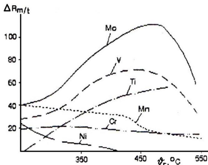
Slika 5. Utjecaj legiranja na promjenu statičke izdržljivosti pri različitim radnim temperaturama [1]
