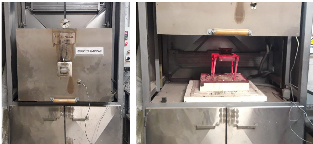
Slika 63. Kalup u peći
