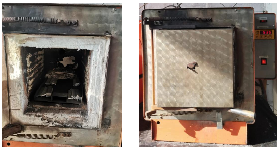
Slika 60. Prekursori u peći za toplinsku obradu
