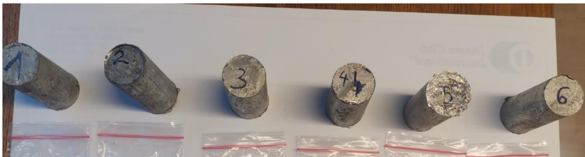
Slika 68. Uzorci prije tlačenja
