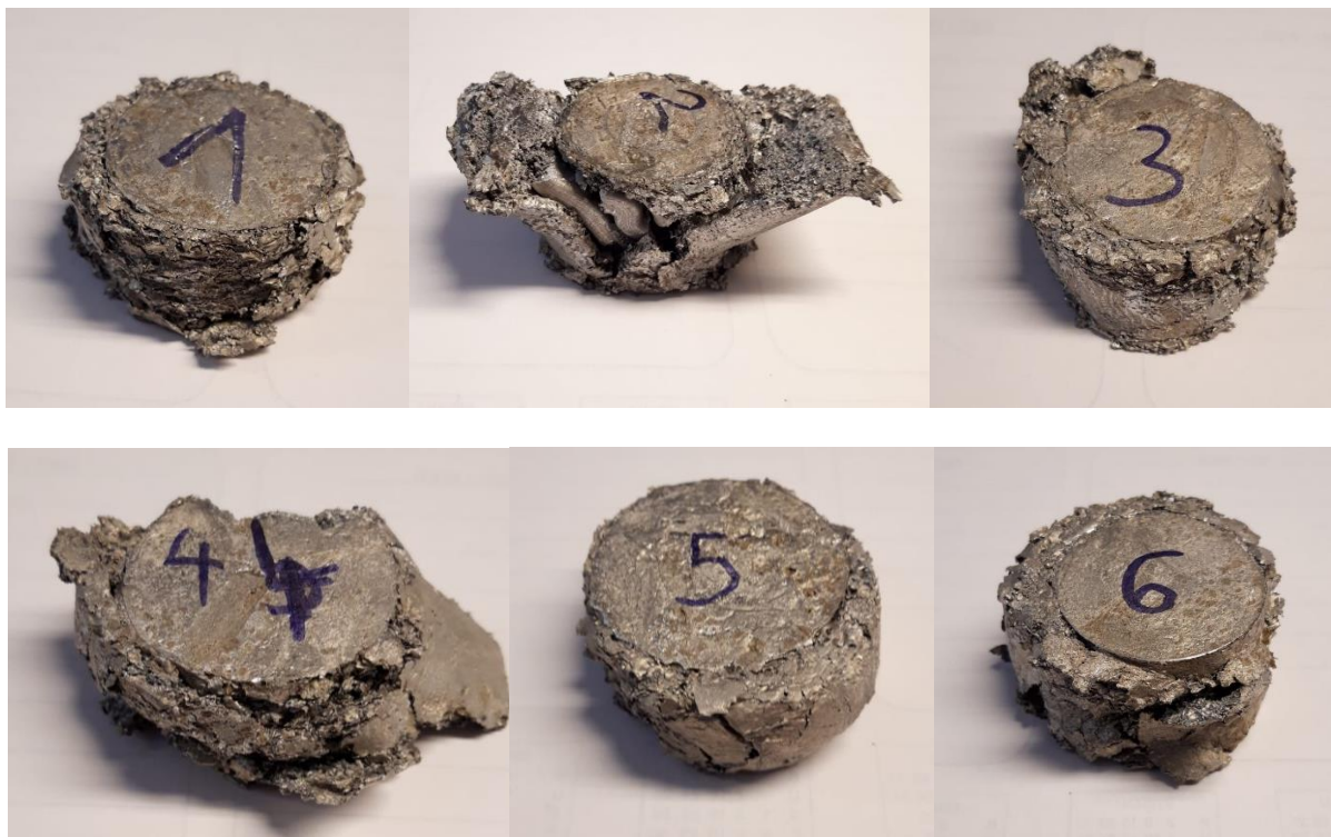
Slika 81. Pojedinačni izgled uzoraka nakon tlačenja
