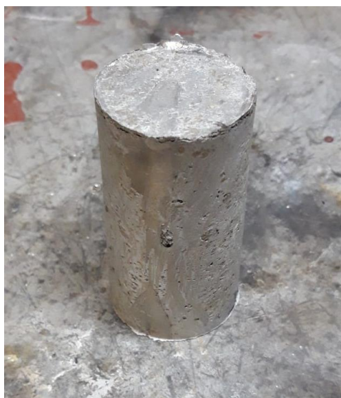
Slika 65. Izrađeni uzorak aluminijske pjene
