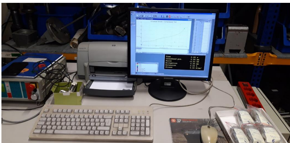
Slika 67. Program TIRatest System povezan s kidalicom
