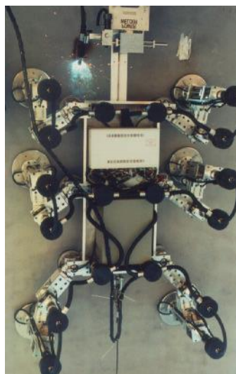
Slika 2. REST, šestero nožni robot [2]
