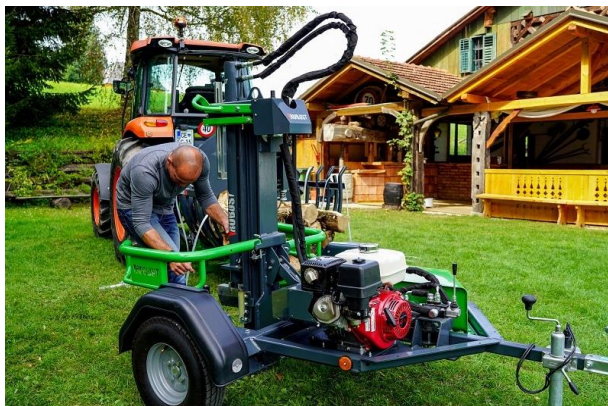
Slika 7: Cjepač pogonjen benzinskim motorom „Robust BA“ [5]
