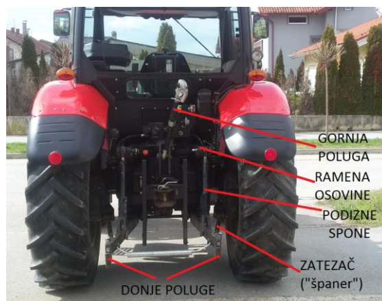
Slika 19: Stražnja poteznica traktora „Zetor Proxima“ u 3 točke
