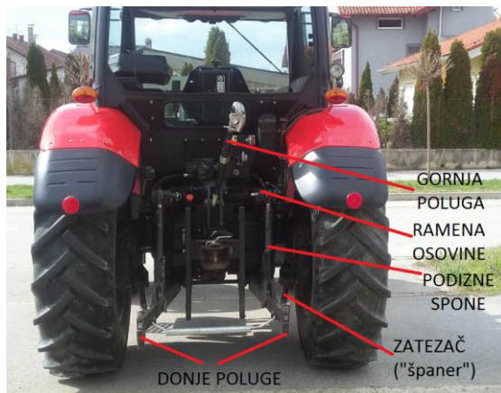
Slika 19: Stražnja poteznica traktora „Zetor Proxima“ u 3 točke
