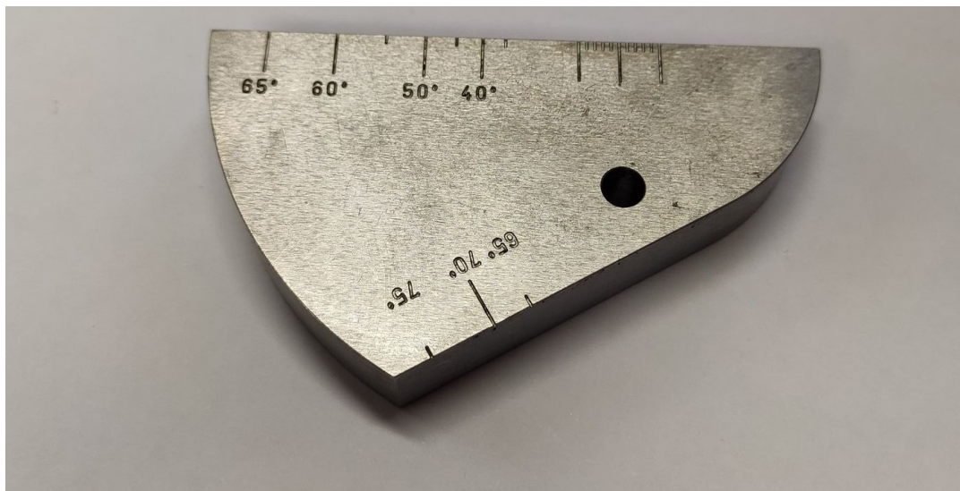
Slika 36. Referentni etalon V2
