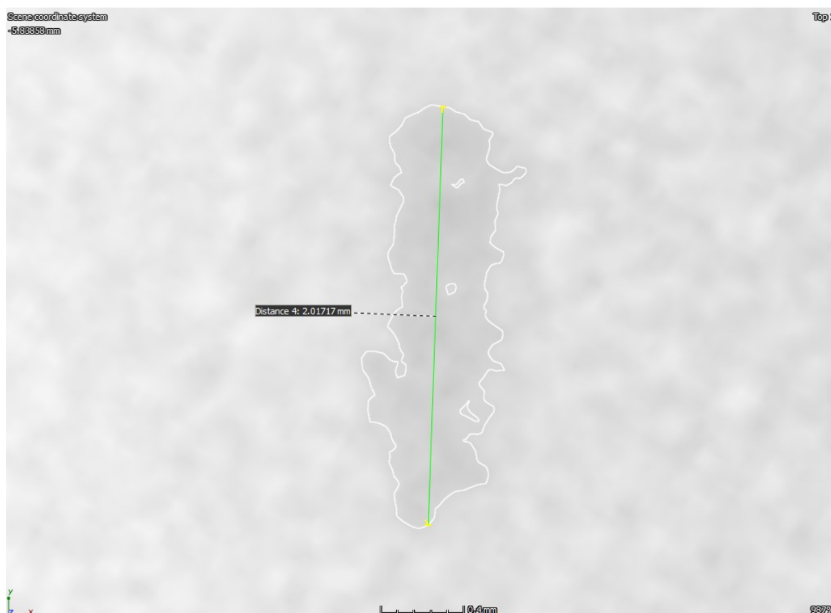
Slika 33. CT snimka referentnog reflektora pod kutom 70°
