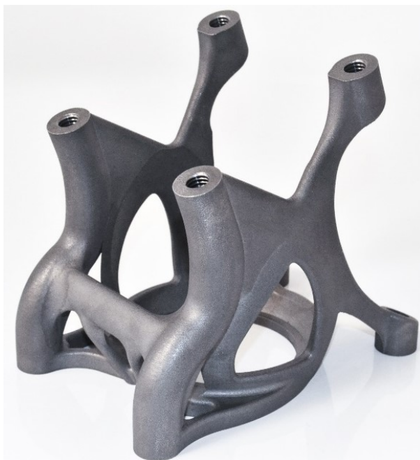
Slika 25. Metalna tvorevina izrađena aditivnim postupkom DMLS [21]
