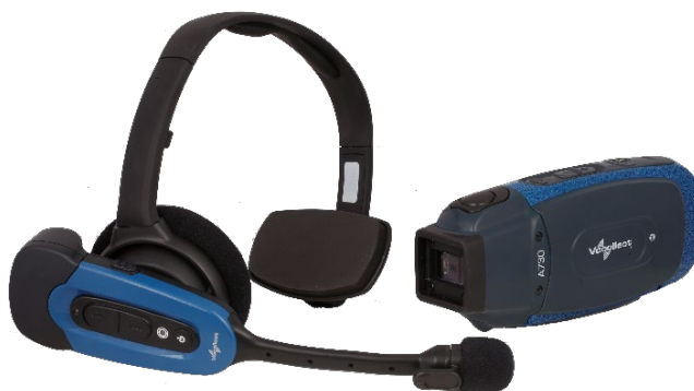
Slika 33. Slušalice i terminal za glasom usmjereno komisioniranje
