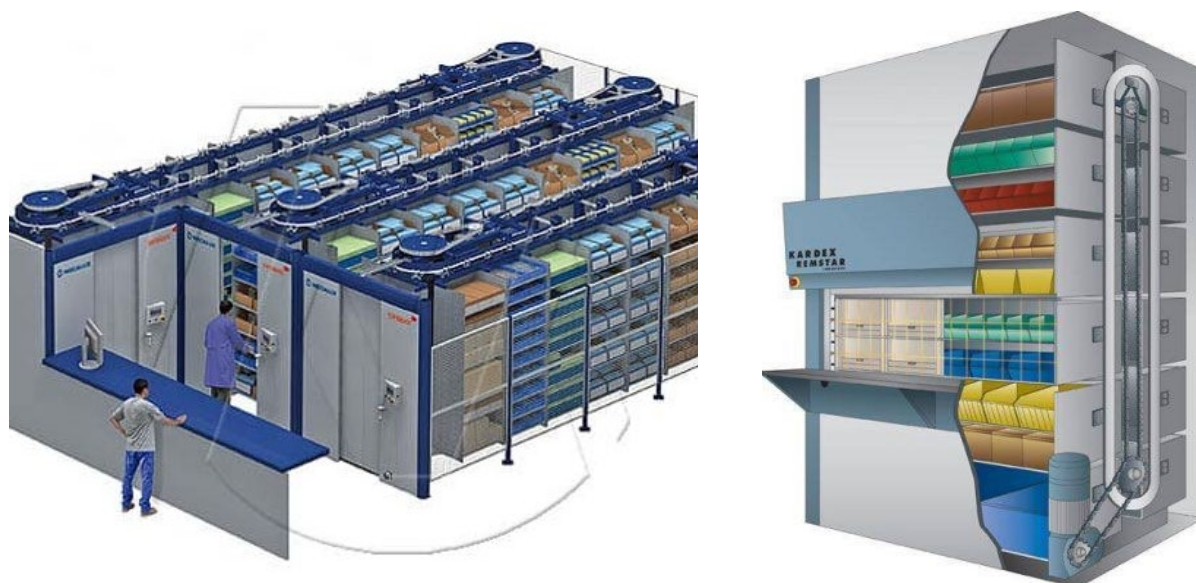
Slika 15. Horizontalni i vertikalni karuseli
