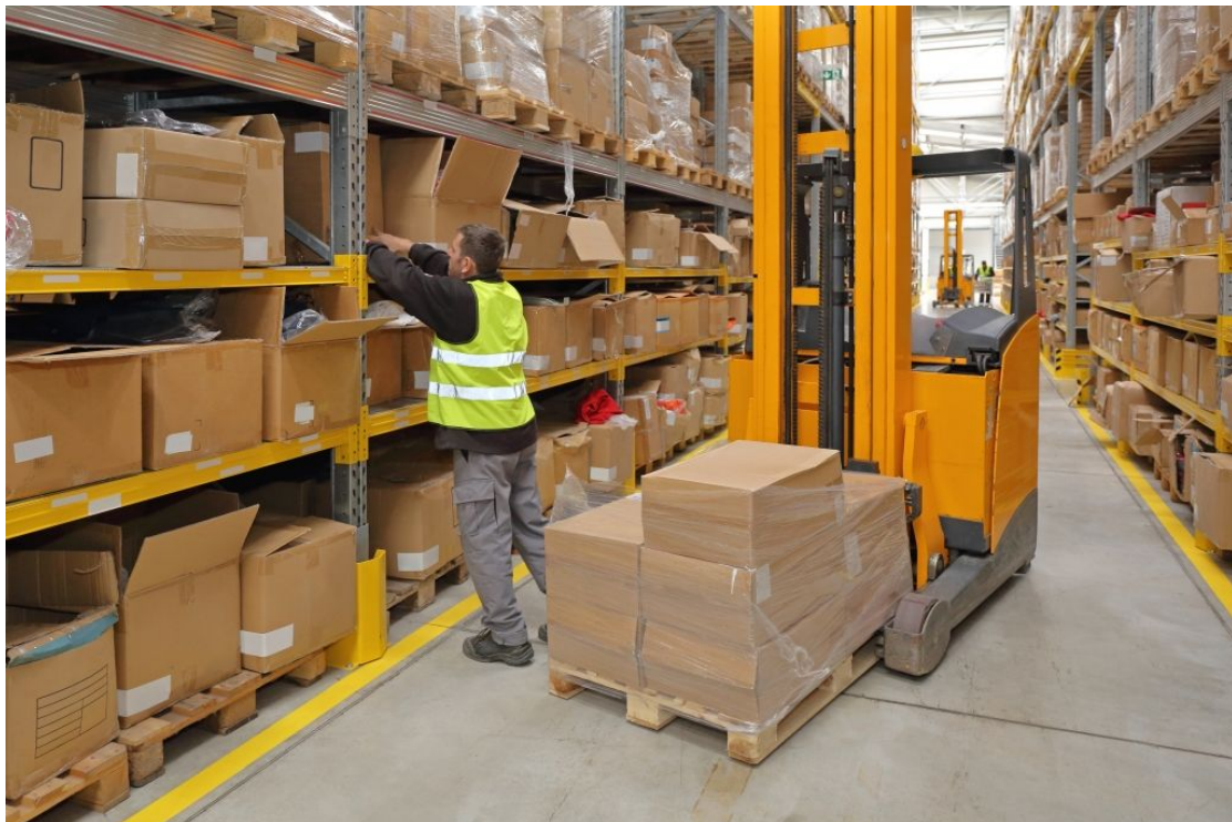
Slika 9. Realni primjer komisioniranja prema principu „čovjek robi“
