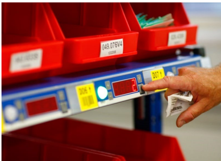
Slika 28. „Pick to light“ sustav
