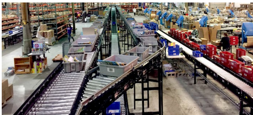
Slika 22. Sustav konvejera za komisioniranje
