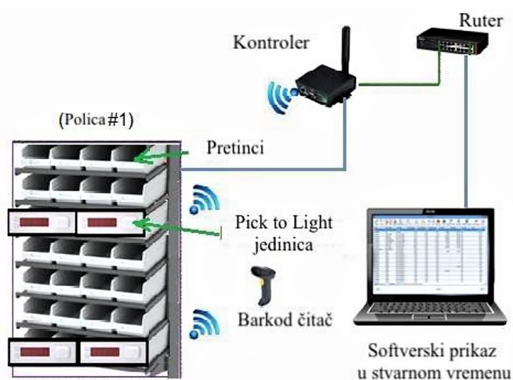
Slika 29. Arhitektura „Pick to light“ sustava
