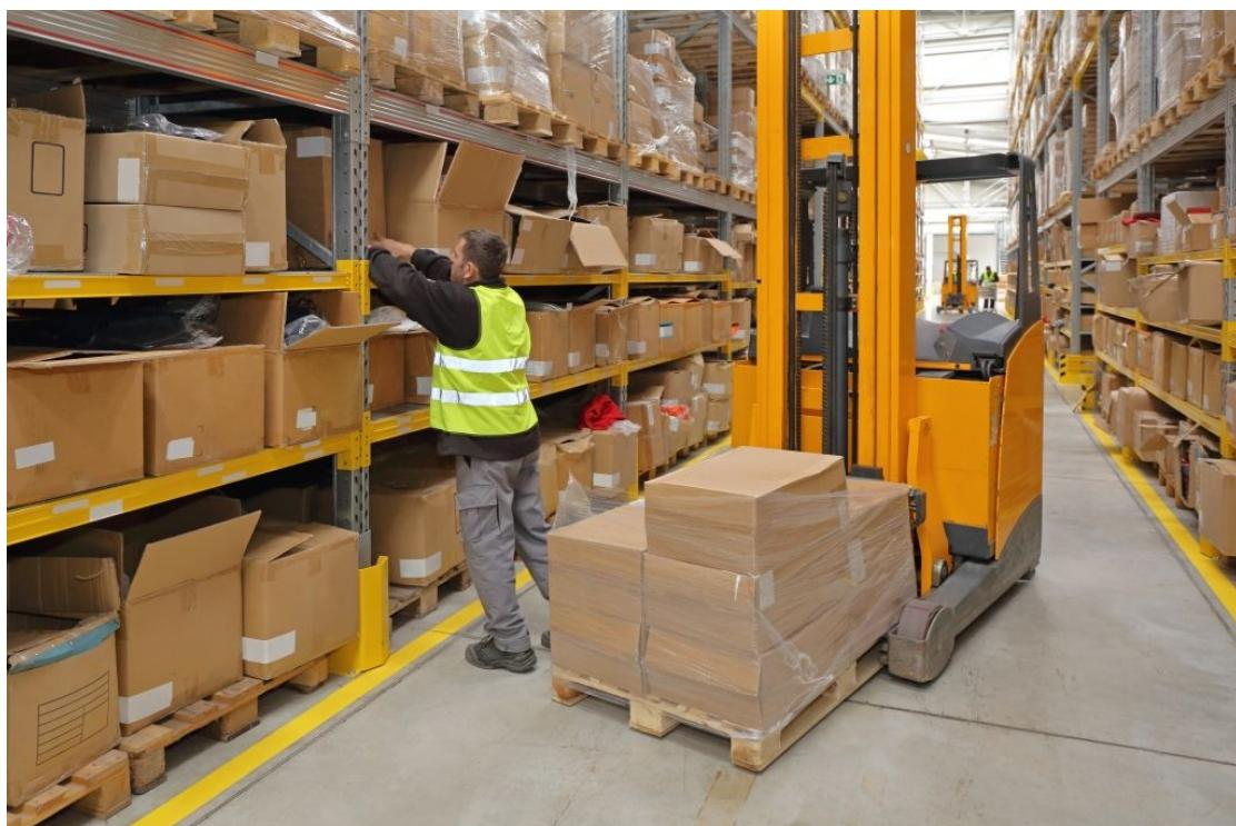
Slika 9. Realni primjer komisioniranja prema principu „čovjek robi“
