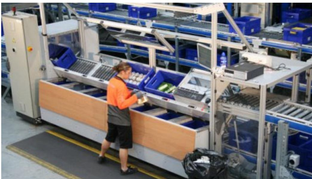
Slika 11. Primjer komisioniranja prema principu „roba čovjeku“ – SSI SCHAEFER
