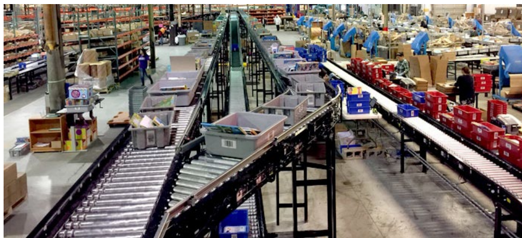
Slika 22. Sustav konvejera za komisioniranje
