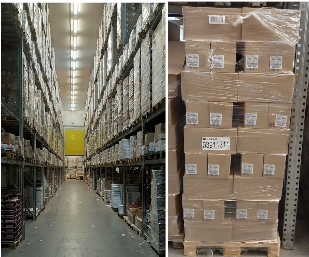
Slika 42. SSI SCHAEFER PR600 sustav regala (lijevo) i uskladištena paleta proizvoda (desno)
