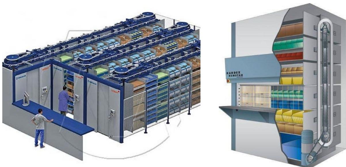
Slika 15. Horizontalni i vertikalni karuseli
