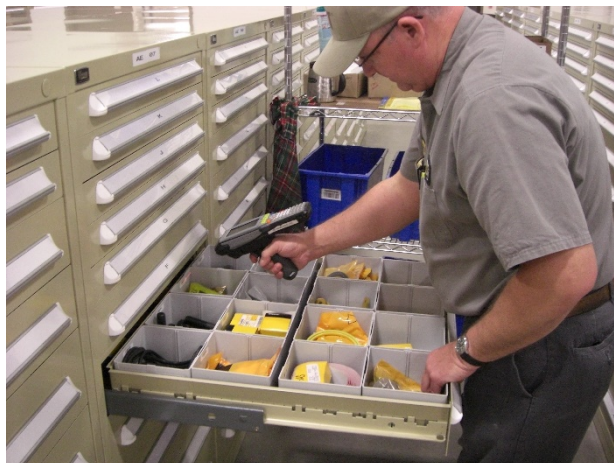
Slika 27. Motorola RF barkod terminal i primjer uporabe
