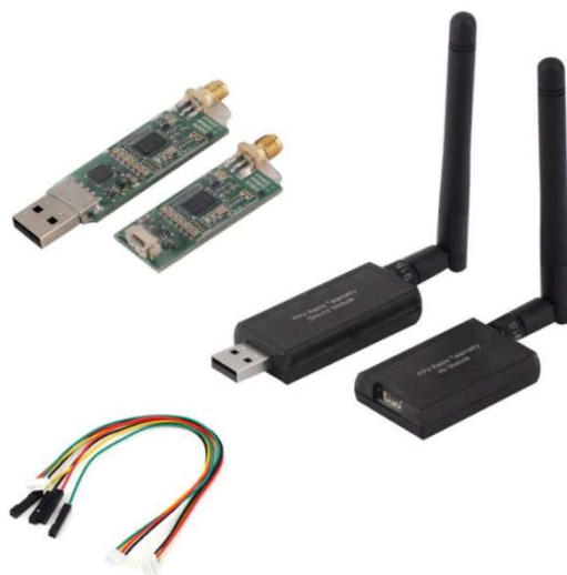
Slika 5.11 433 MHz SiK telemetrijski modul kompatibilan s PX4 firmware-om
