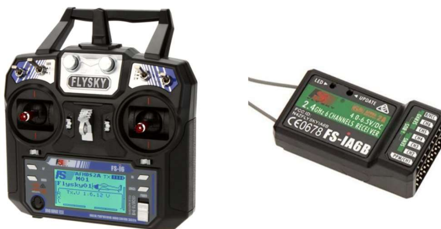
Slika 5.9 FlySky FS-i6 odašiljač (lijevo) i FlySky FS-iA6B prijemnik (desno)
