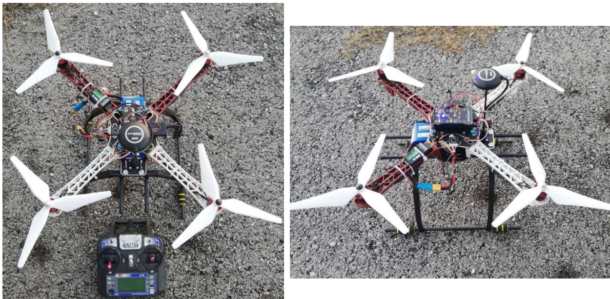
Slika 5.12 Izrađen fizički model kvadkoptera
