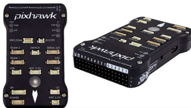
Slika 5.8 Pixhawk 1 kontroler leta (FC)
