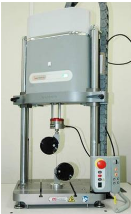
Slika 4.12 Naprava namijenjena za SVI čeličnih žica [12]
