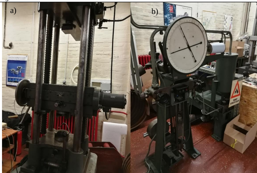
Slika 3.3 Nosiva konstrukcija kidalice i sustav za očitavanje
