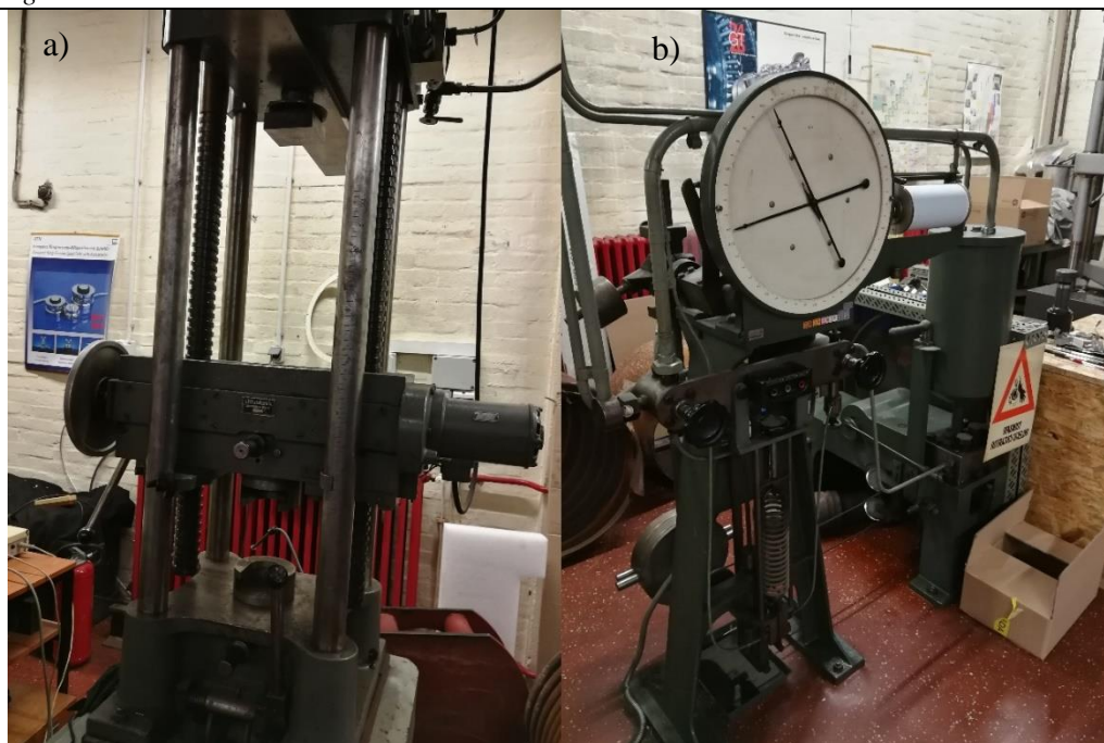
Slika 3.3 Nosiva konstrukcija kidalice i sustav za očitavanje
