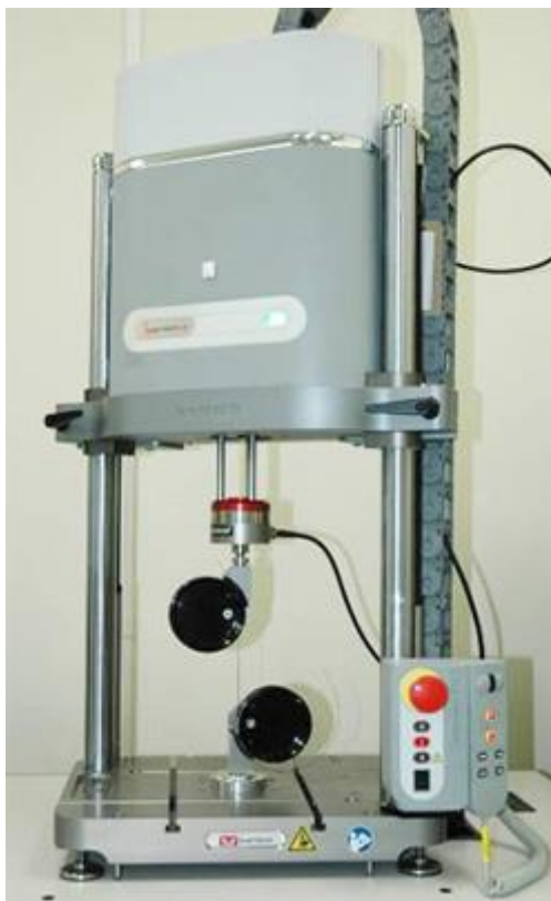
Slika 4.12 Naprava namijenjena za SVI čeličnih žica [12]
