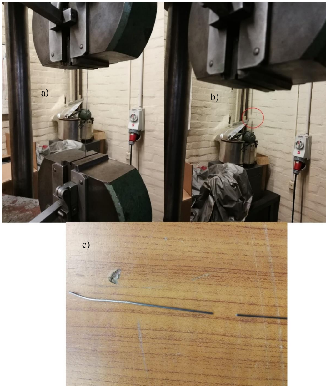
Slika 3.17 Statičko vlačno ispitivanje čelične žice
