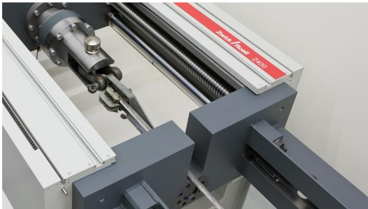
Slika 4.3 Moderna Zwick-ova kidalice za ispitivanje užadi [11]
