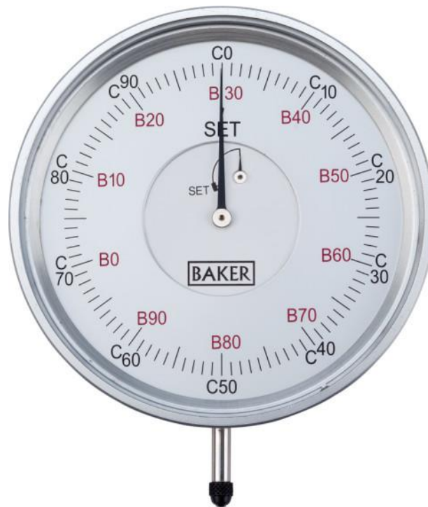
Slika 3.4. Mjerilo Rockwell tvrdomjera [8]
