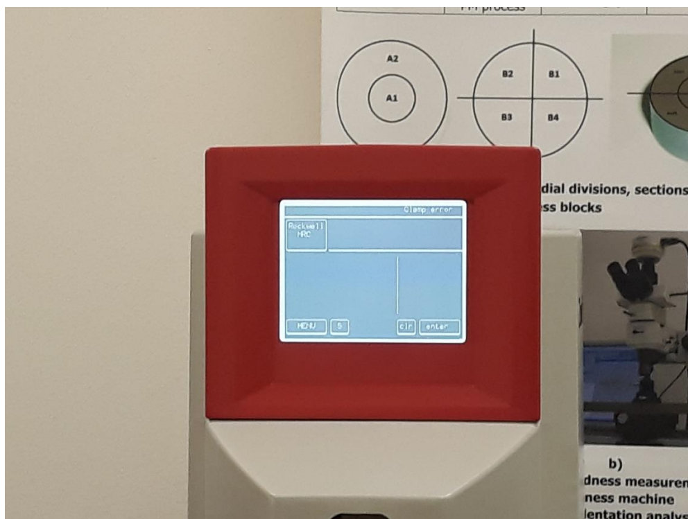
Slika 5.2. Digitalni pokazivač tvrdomjera Indentec ZHR 8150 TKS
