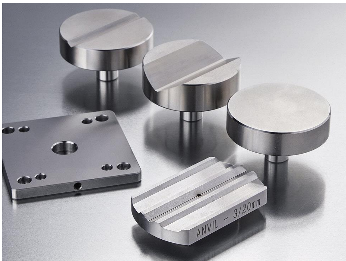
Slika 3.5. Varijante postolja za ispitne uzorke [9]
