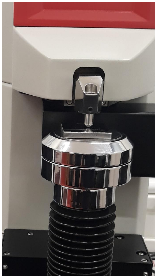
Slika 5.9. Trenutak utiskivanja indentora u pločicu prilikom umjeravanja
