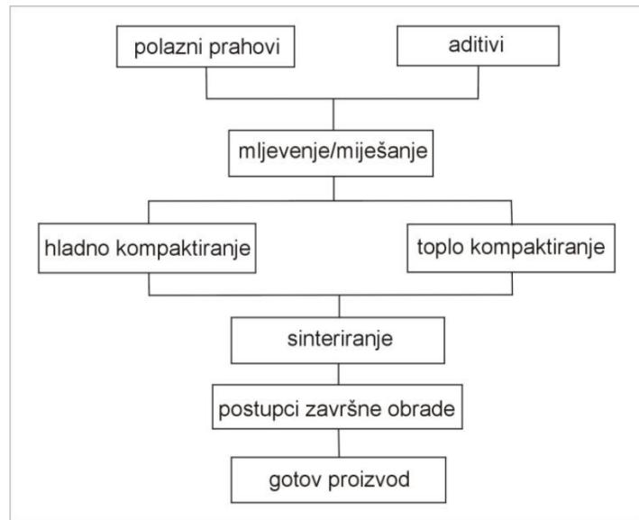
**Slika 1: Slijed operacija pri dobivanju proizvoda metalurgijom praha [2]**
