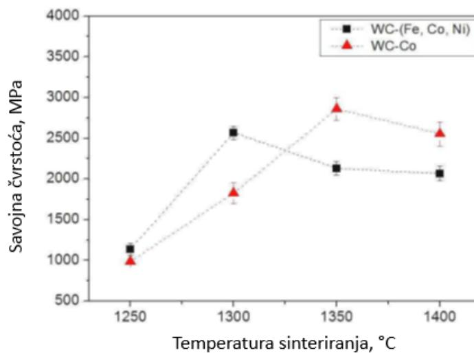
Slika 20: Usporedba savojne čvrstoće nanostrukturiranih WC-Fe-Ni-Co i WC-Co [21]
