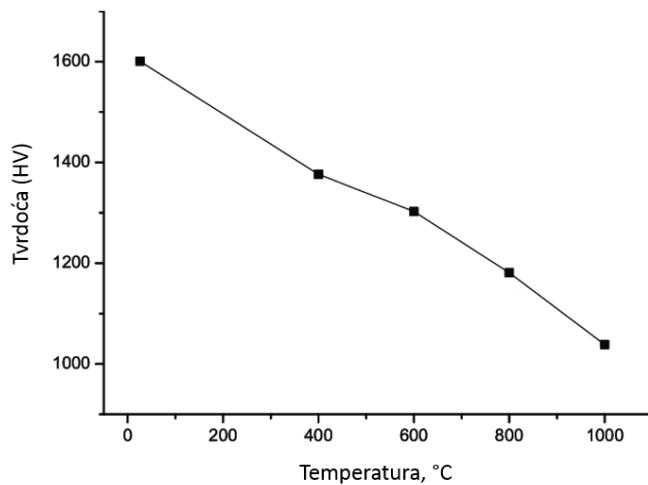
Slika 9: Utjecaj temperature primjene na tvrdoču tvrdih metala [13]
