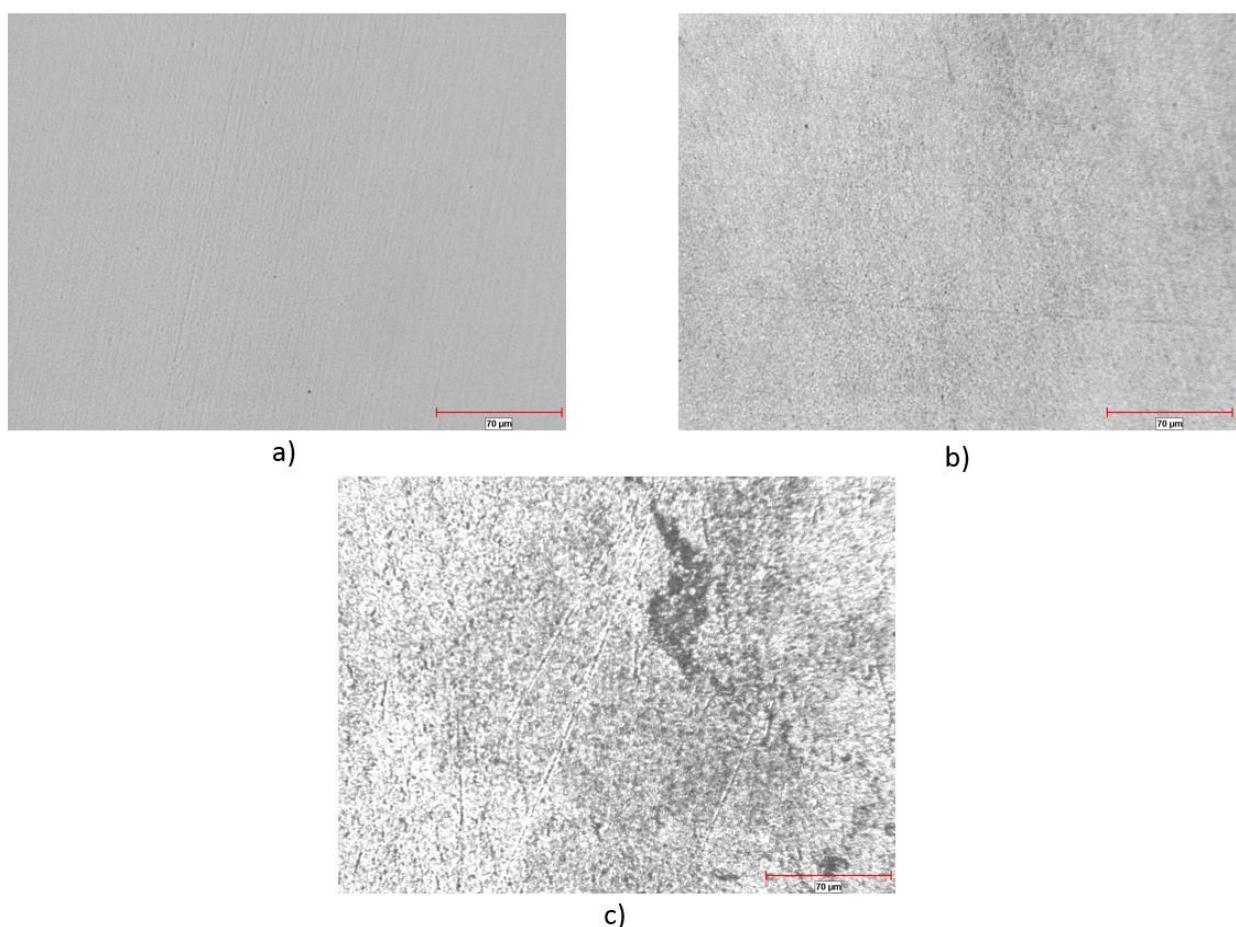
**Slika 47: Nagrižene površine WC-11Ni uzorka pri povećanju 200x**
