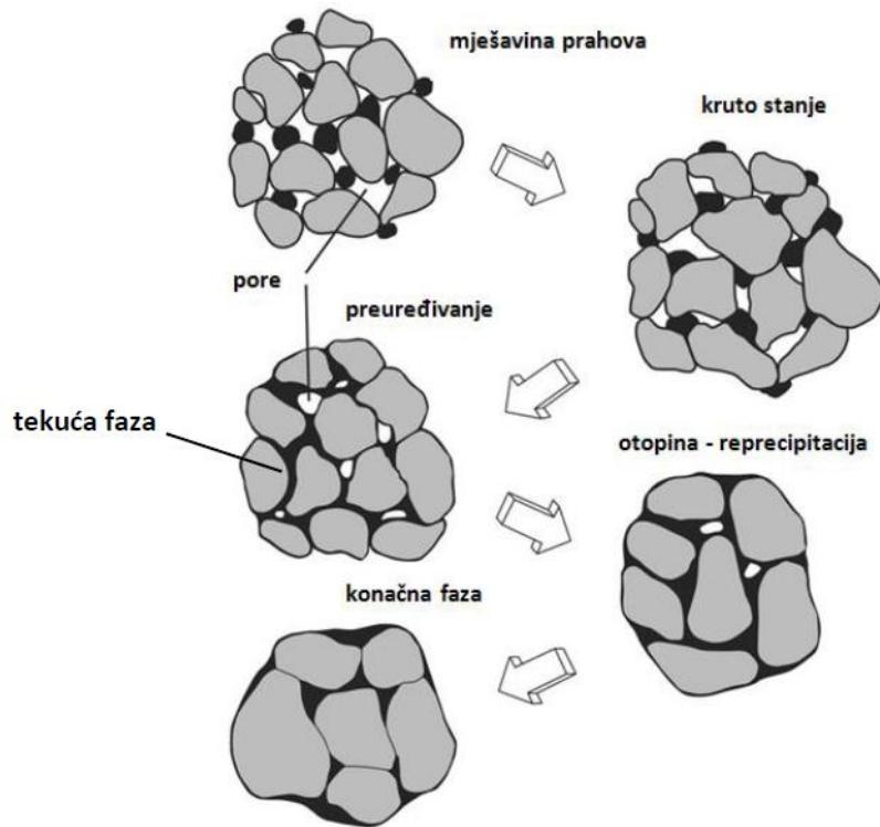
Slika 2: Faze sinteriranja u rastaljenoj fazi [2]
