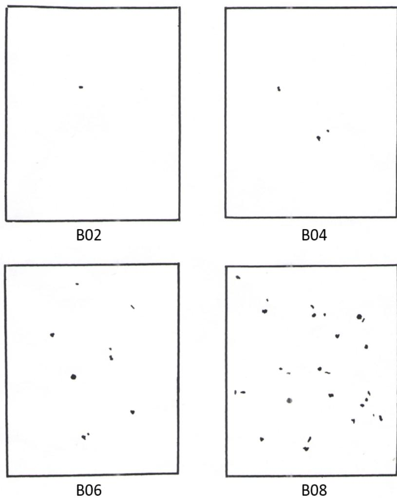
**Slika 41:** Fotomikroografi poroziteta B02, B04, B06 i B08 pri povećanju 100x [38]
