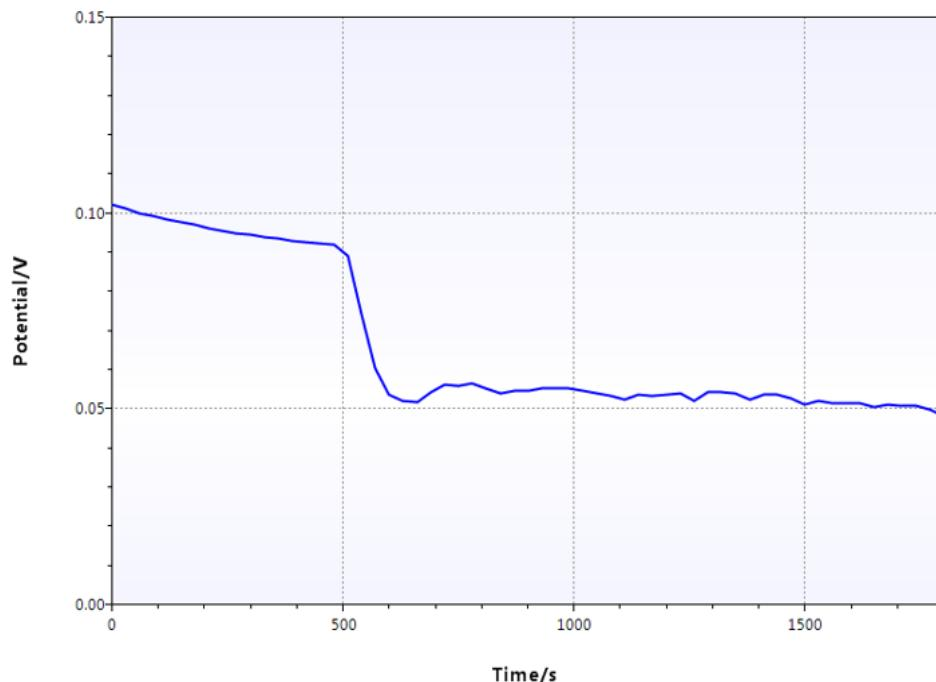
Slika 55: Mjerenje koroziskog potencijala WC-11Ni uzorka
