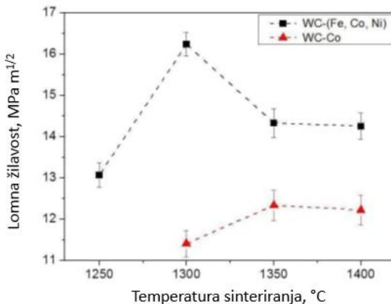
**Slika 21: Usporedba lomne žilavosti nanostrukturiranih WC-Fe-Ni-Co i WC-Co [21]**
