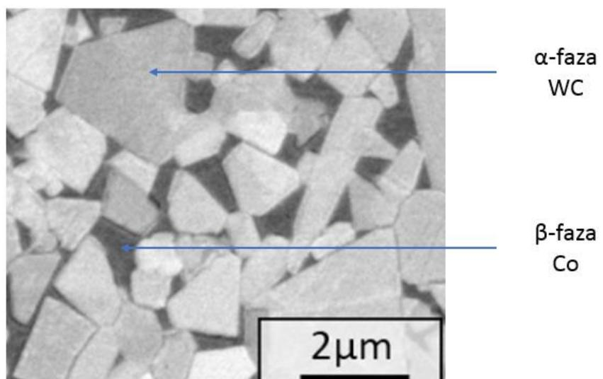
Slika 6: Dvofazna mikrostruktura WC-Co tvrdog metala [12]
