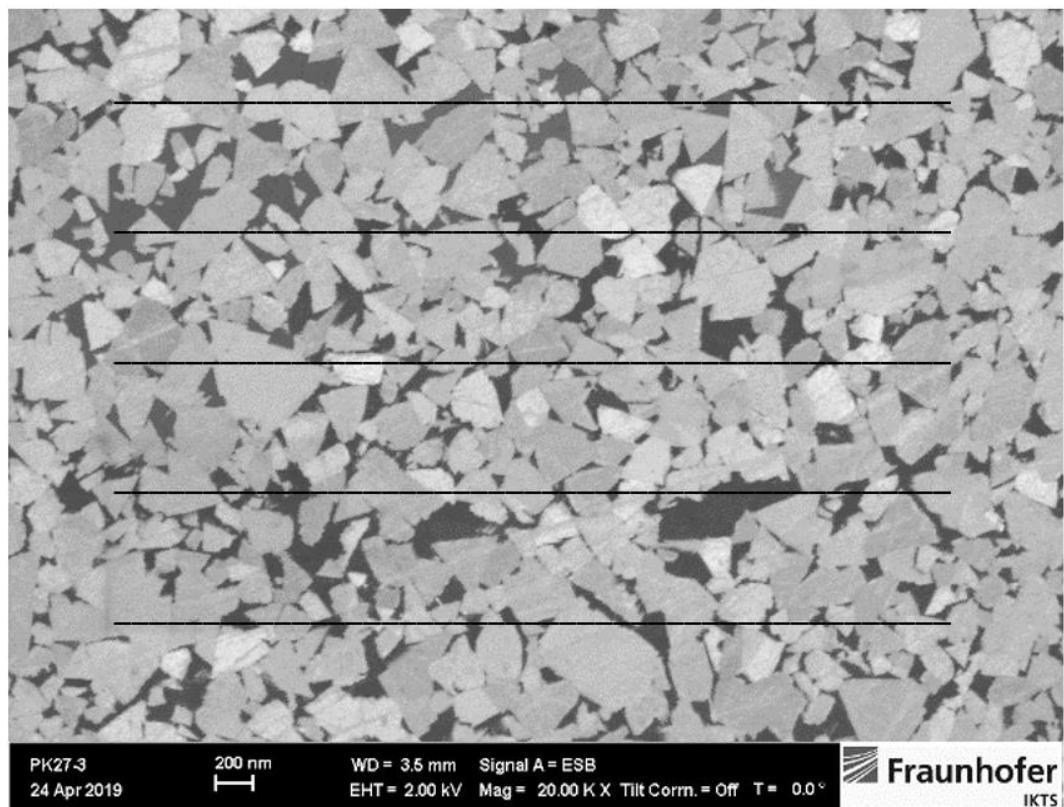
Slika 50: FESEM snimka WC-11Co uzorka pri povećanju 20 000x
