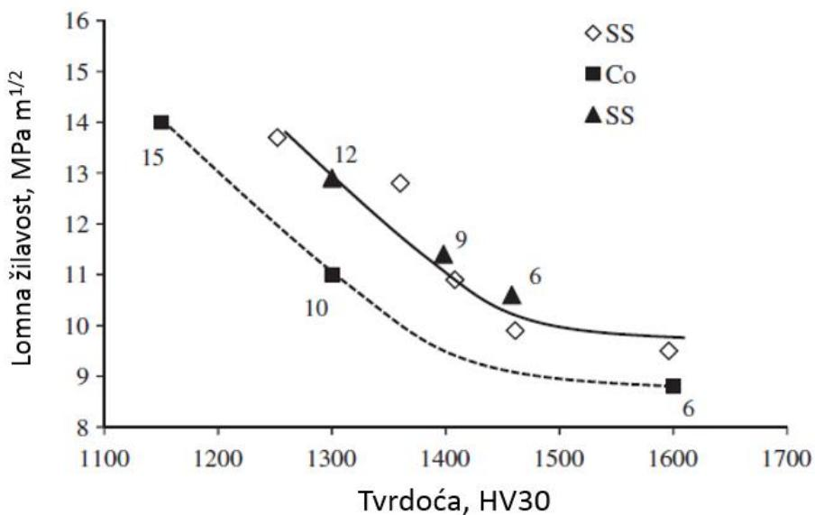
Slika 26: Usporedba mehaničkih svojstava WC-AISI304 i WC-Co [24]
