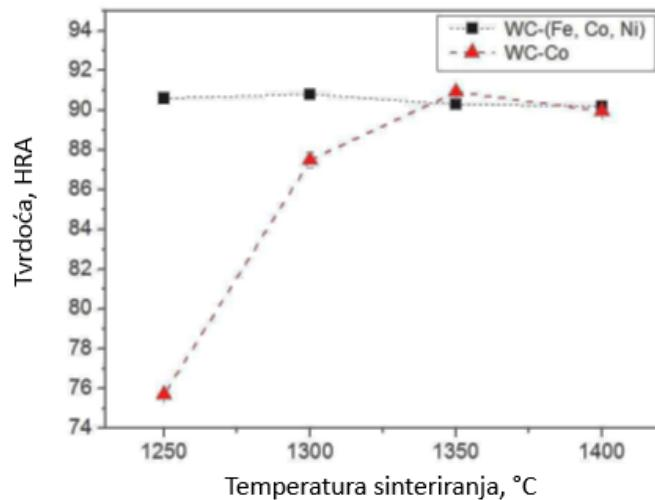
Slika 19: Usporedba tvrdoće nanostrukturiranih WC-Fe-Ni-Co i WC-Co [21]
