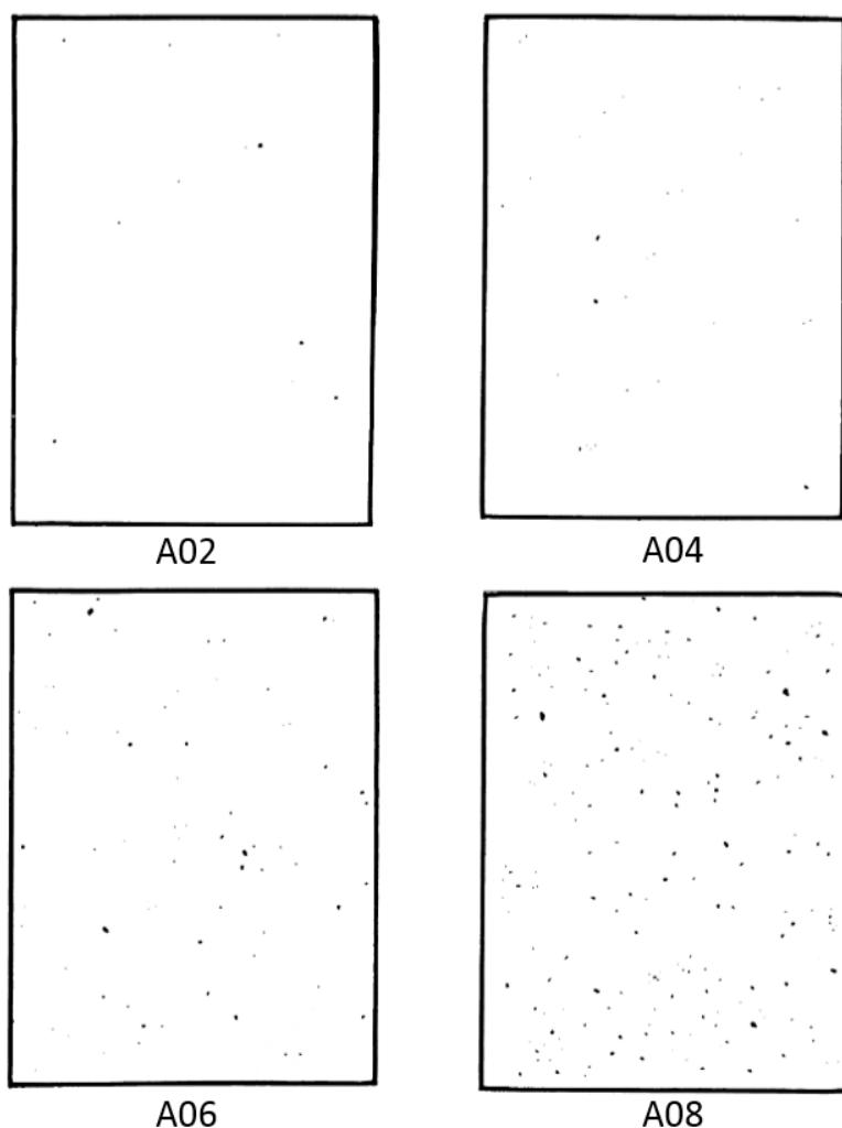
Slika 40: Fotomikroografi poroziteta A02, A04, A06 i A08 pri povećanju 200x [2]
