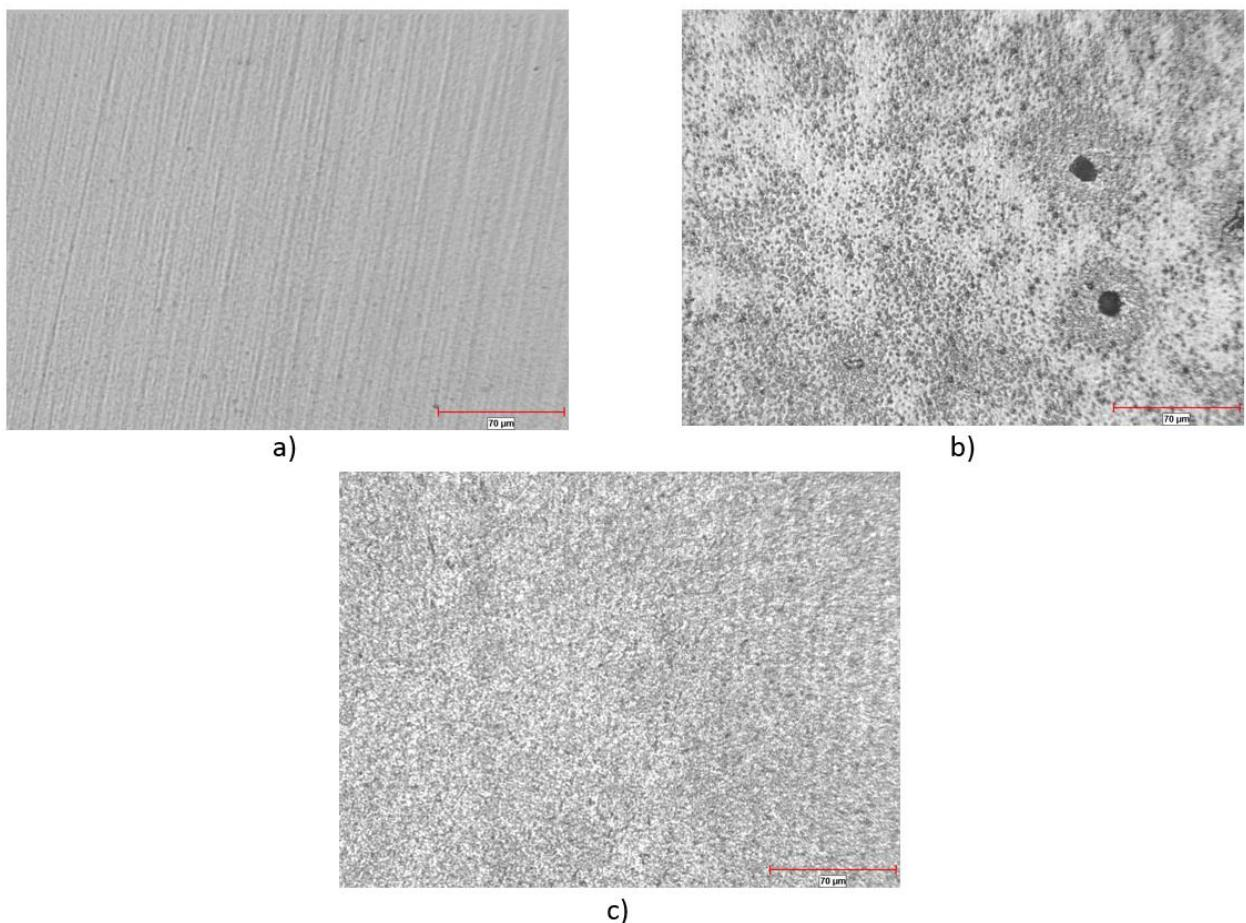
**Slika 48: Nagrižene površine WC-11Co uzoraka pri povećanju 200x**
