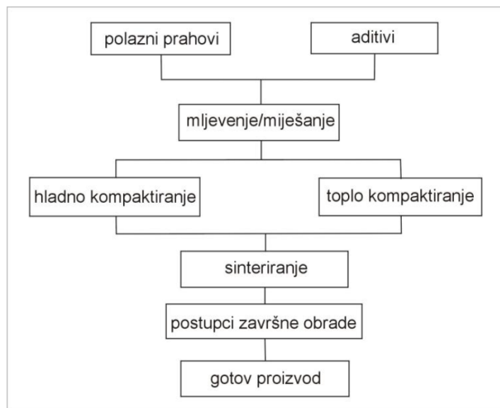
Slika 1: Slijed operacija pri dobivanju proizvoda metalurgijom praha [2]
