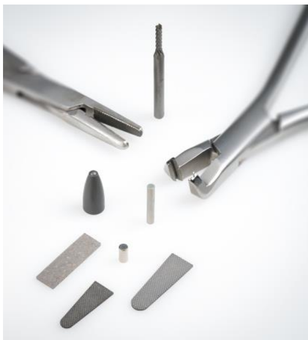
Slika 34: Primjeri uporabe tvrdih metala u medicinskoj industriji [33]
