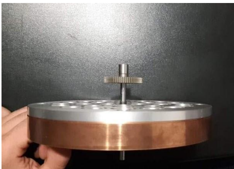
Slika 36 – Sklop bakrenog zamašnjaka, aluminijskog poklopca, vratila jedan i zupčanika
