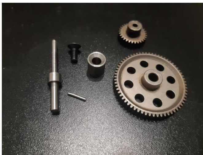
Slika 37 – Zupčasti prijenosnik, čahura, vijak s opuštenom glavom M6x5, vratilo dva
