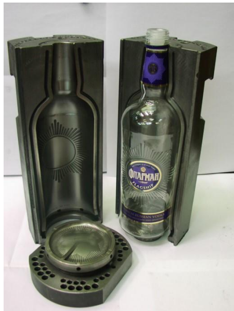
Slika 19 Kalup, dno kalupa i gotov proizvod [6]
