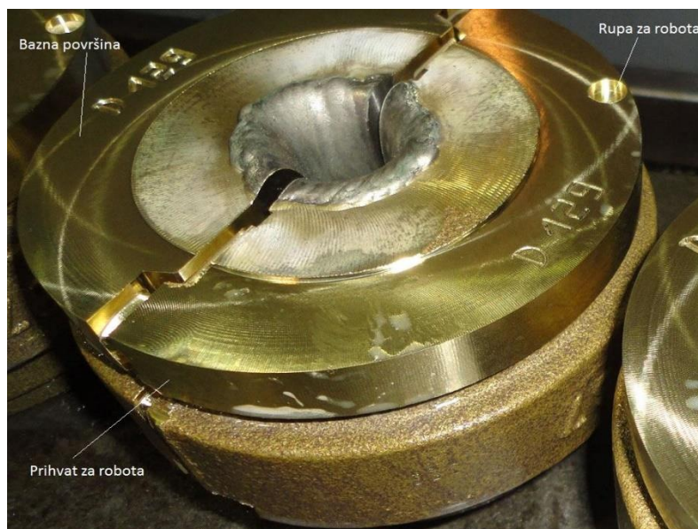
Slika 39 Grlo nakon vertikalnog glodanja POMET [6]
