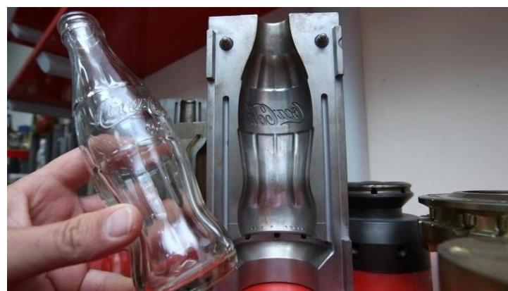
Slika 2 Primjer kalupa iz tvrtke OMCO [4]
