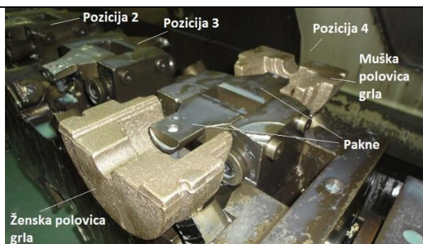
Slika 37 Grlo na stroju za glodanje [6]
