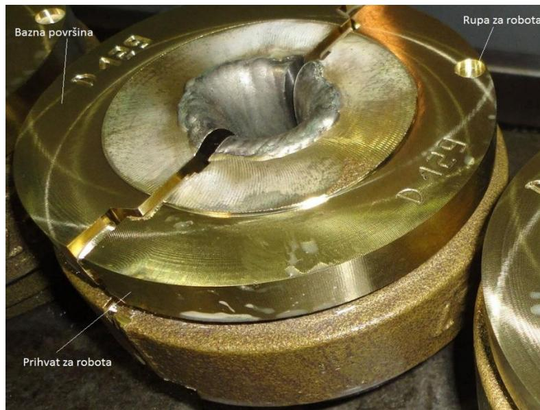
**Slika 39 Grlo nakon vertikalnog glodanja POMET [6]**
