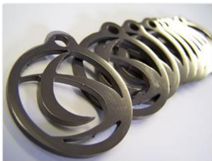
Slika 22. Primjer primjene postupka vanadiranja (TD) [20]
