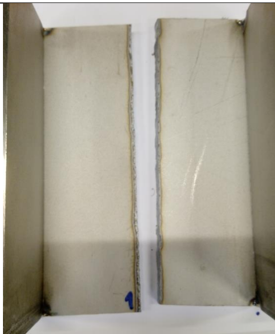
Slika 39. Izgled površine nakon odmaščivanja i čišćenja
