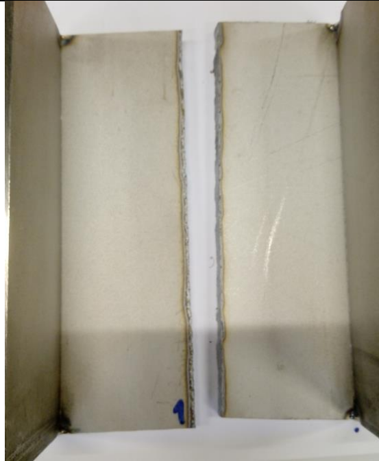
Slika 39. Izgled površine nakon odmaščivanja i čišćenja
