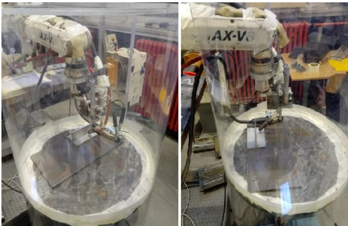
Slika 40. Prikaz položaja robotske ruke, pištolja i uzorka tijekom zavarivanja kutnog spoja
