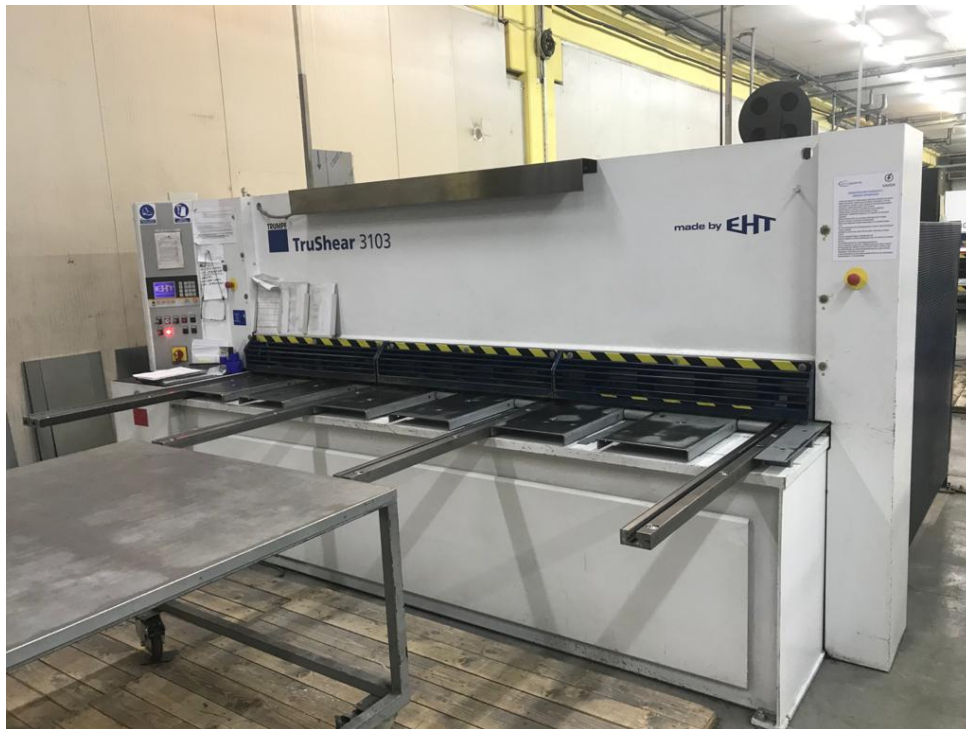
Slika 35. TruShear 3103 škare za rezanje lima
