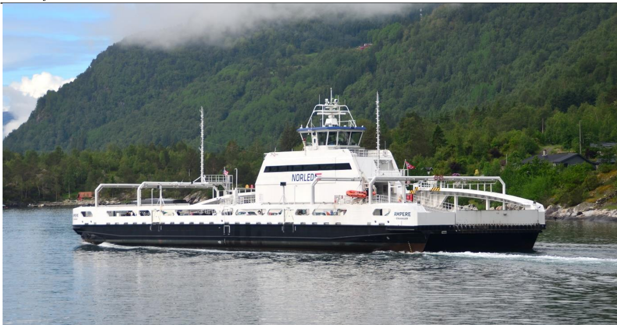
Slika 9. Norveški potpuno električni trajekt MV Ampere [36]
