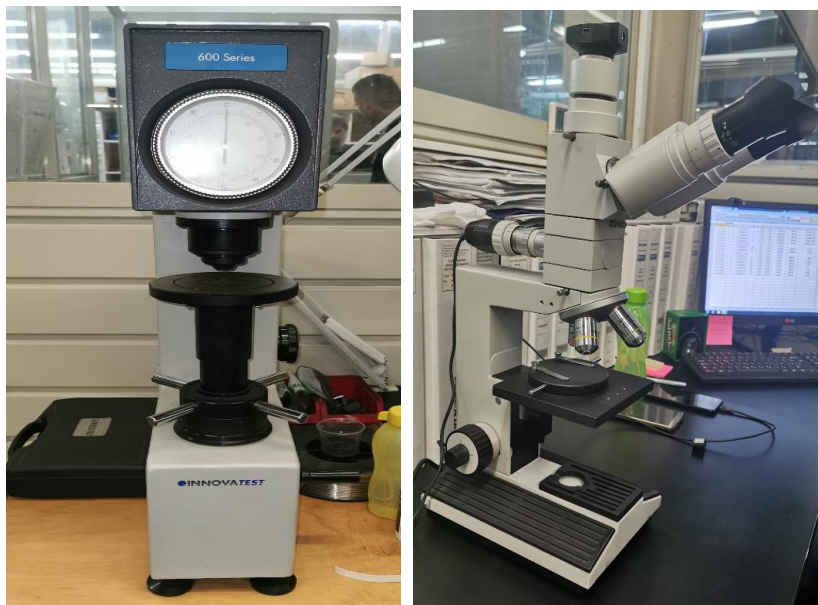
Slika 34. Tvrdomjer za određivanje metode Rockwell C testa i mikroskop za uvećanje traga trošenja
