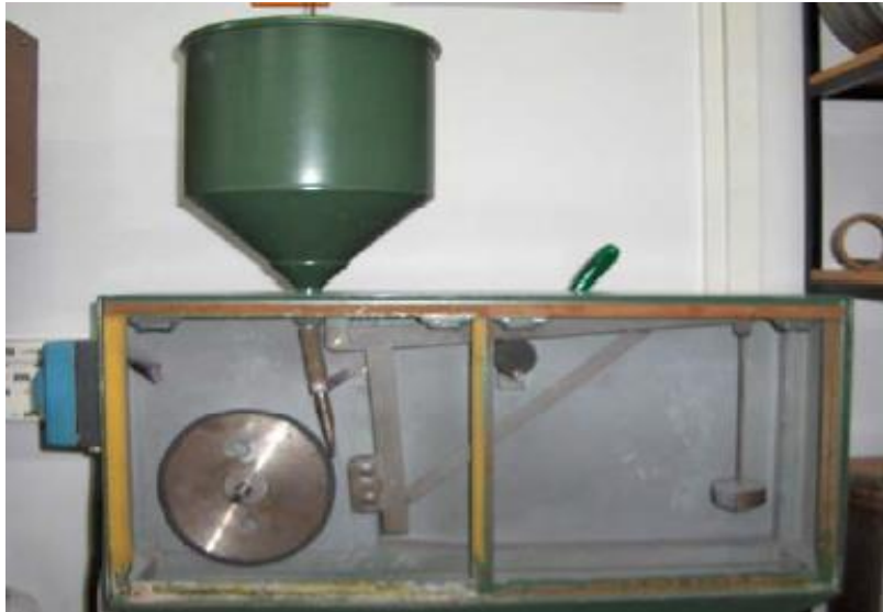
Slika 36. Prikaz uređaja “suhi pijesak/gumeni kotač”
