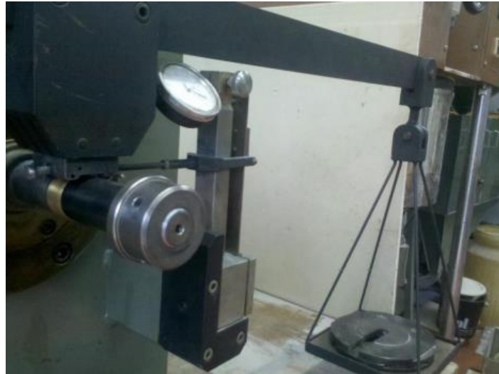
Slika 38. Prikaz uređaja "prizma po prstenu"
