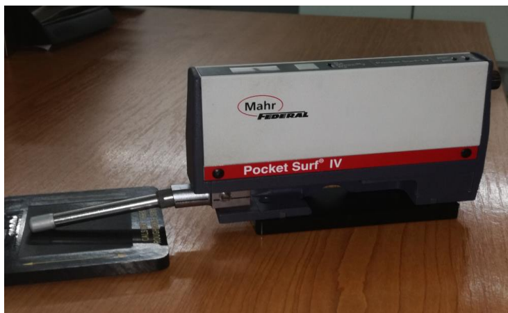
Slika 28. Uređaj za mjerenje hrapavosti površine Pocket Surf IV, Mahr
