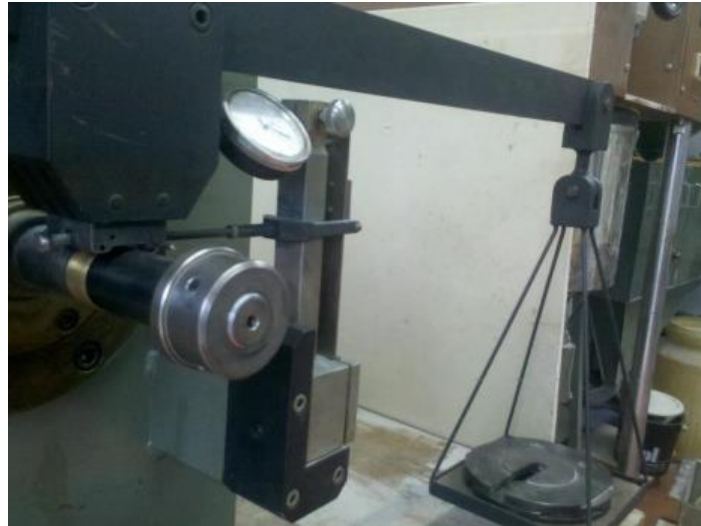
Slika 38. Prikaz uređaja "prizma po prstenu"
