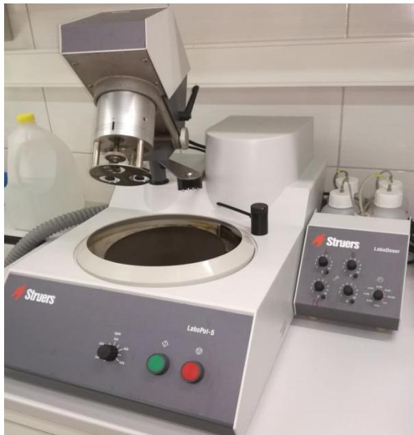
Slika 30. Uredaj za brušenje i poliranje Struers, LaboPol-5
