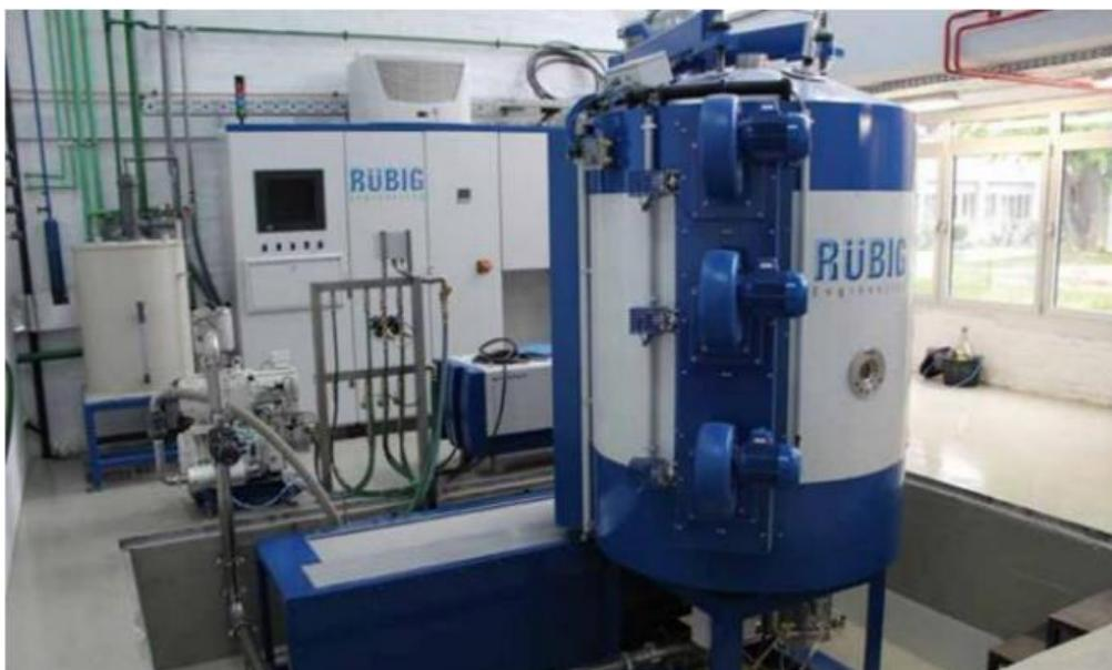
Slika 24. PACVD uređaj tvrtke Rübig instaliran na Fakultetu strojarstva i brodogradnje
