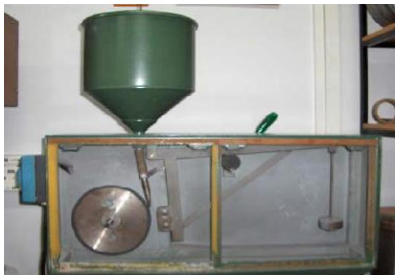
Slika 36. Prikaz uređaja „suhu pjesak/gumeni kotač“
