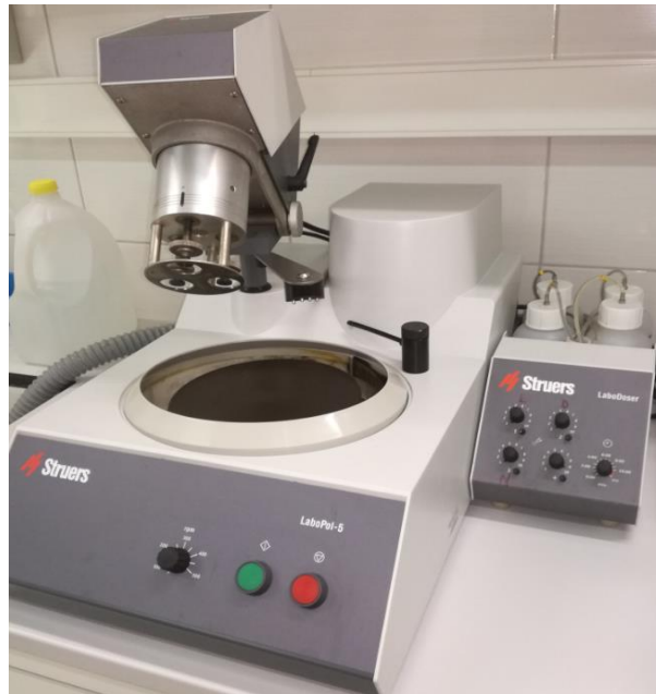
Slika 30. Uređaj za brušenje i poliranje Struers, LaboPol-5
