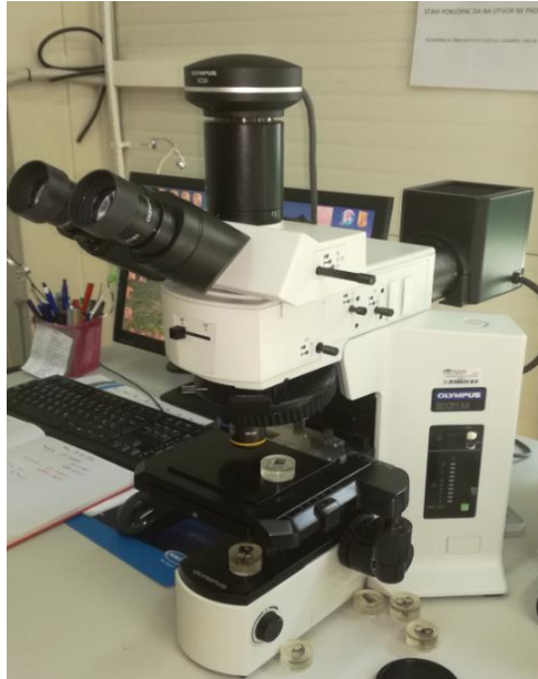
Slika 31. Optički svjetlosni mikroskop Olympus BX51M
