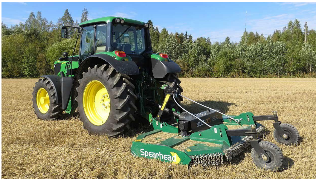
Slika 13. Traktorski priključak spojen kardanom na izlazno vratilo traktora
