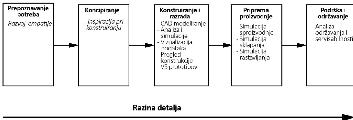
Slika 6 Primjene VS sustava u razvoju proizvoda [32]
