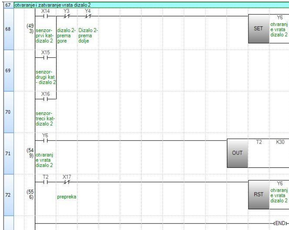
Slika 20. Otvaranje i zatvaranje vrata drugog dizala
