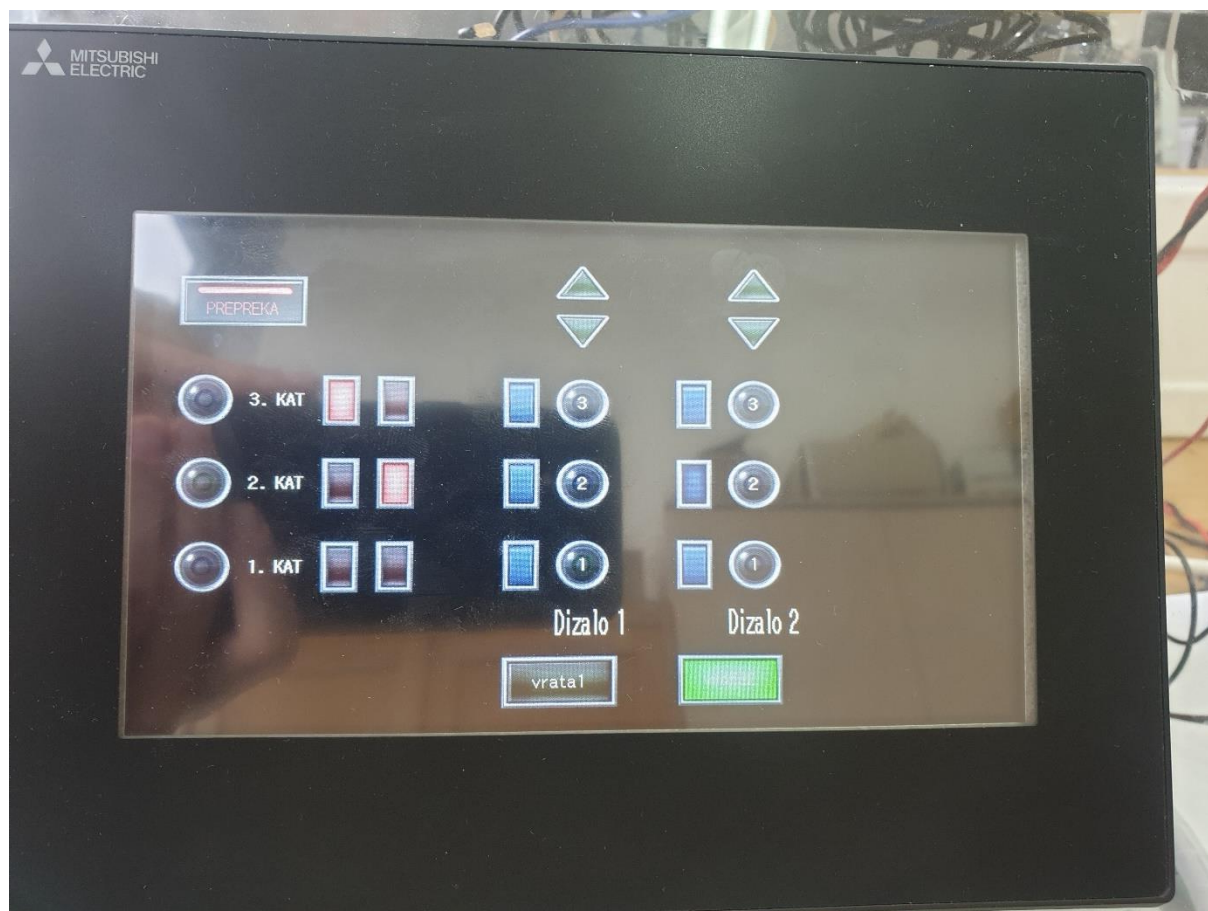
Slika 29. HMI zaslon pri otvaranju vrata drugog dizala uz postojanje prepreke
