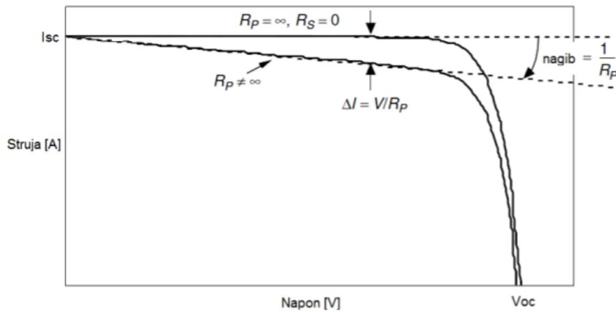
**Slika 15:** UI karakteristika bez i s paralelnim otporom [15]
