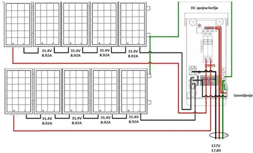
**Slika 32.** Povezivanje FN panela s objedinjenim nizovima [22]
