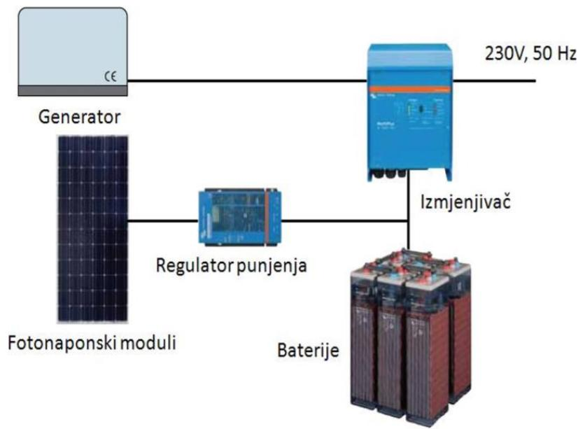
**Slika 26.** Hibridni otočni FN sustav [3]
