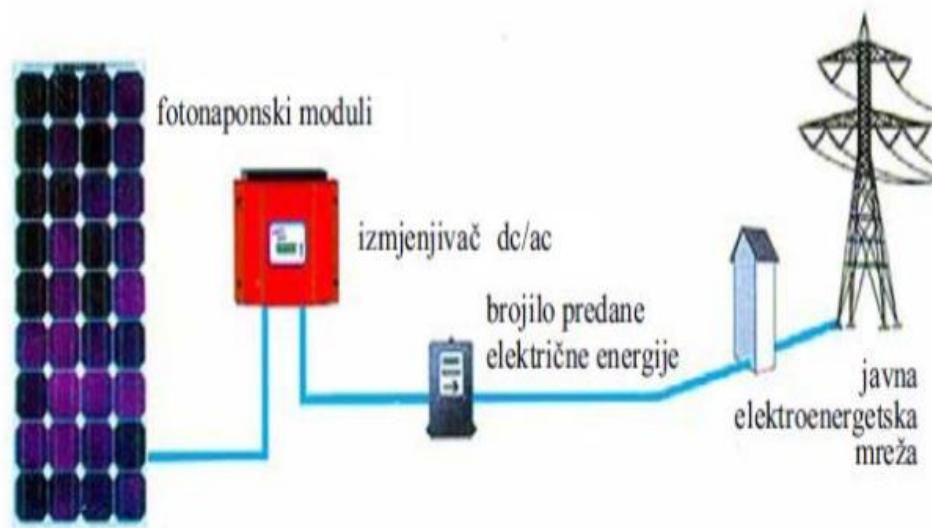
**Slika 28.** FN sustavi direktno spojeni na mrežu [3]
