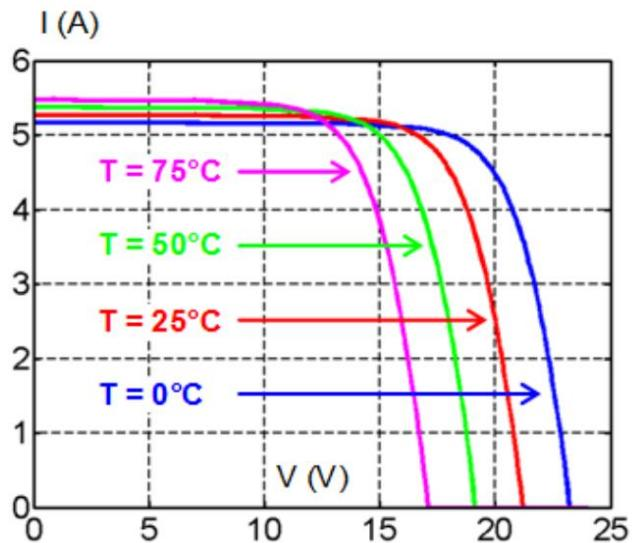
Slika 19. Ovisnost UI karakteristike o temperaturi [17]
