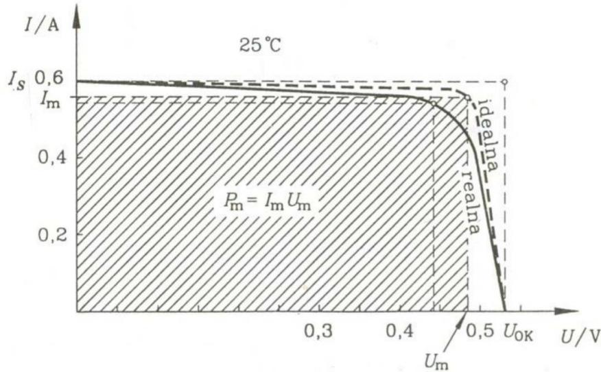
**Slika 17.** UI karakteristika idealnog i realnog FN članka [16]
