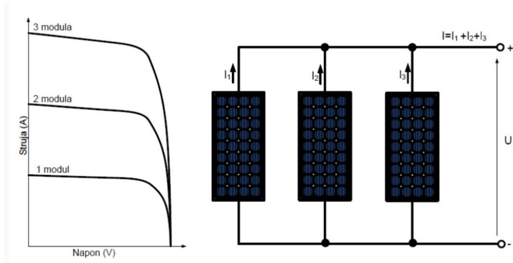
**Slika 24.** Paralelno povezivanje FN modula [19]
