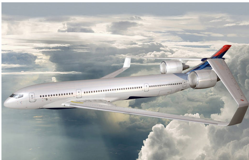
Slika 10. Box wing koncept, Lockheed Martin [12]
