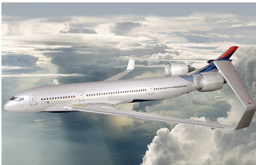
Slika 10. Box wing koncept, Lockheed Martin [12]
