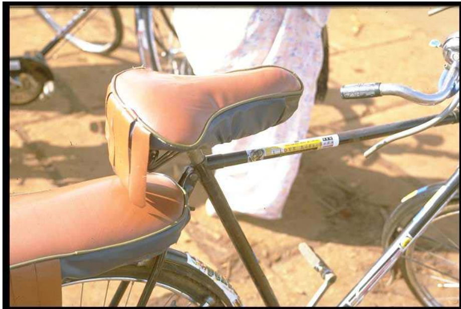
Slika 8: Tipično dvostruko sjedište na boda-boda biciklu
