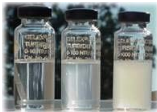
Slika 4: Boce sa vodom od 5, 50 i 500 NTU
