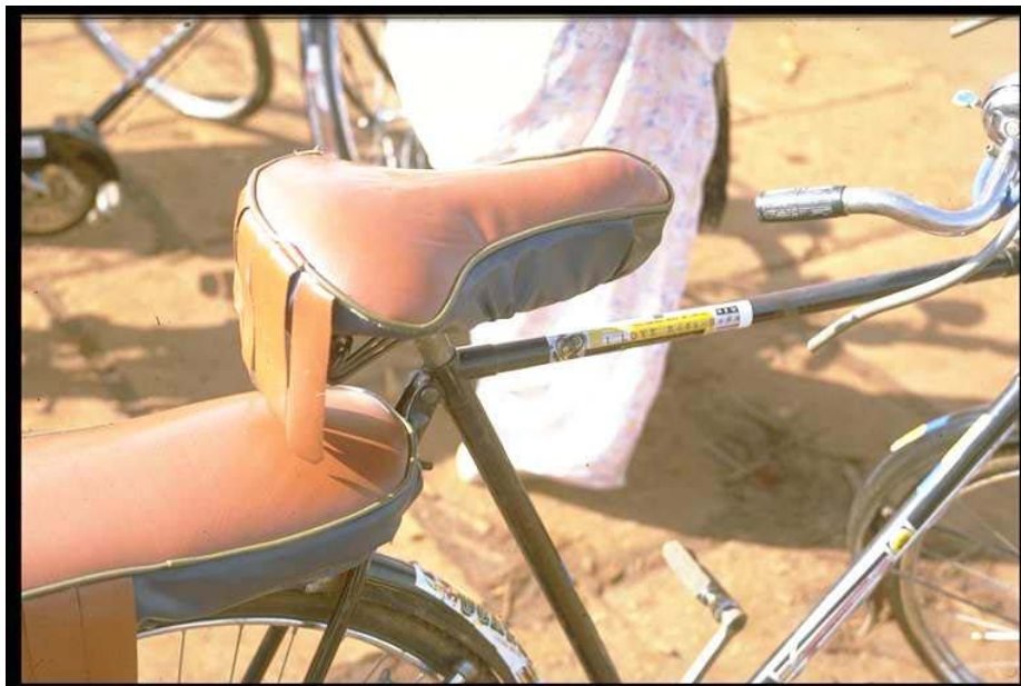
Slika 8: Tipično dvostruko sjedište na boda-boda biciklu
