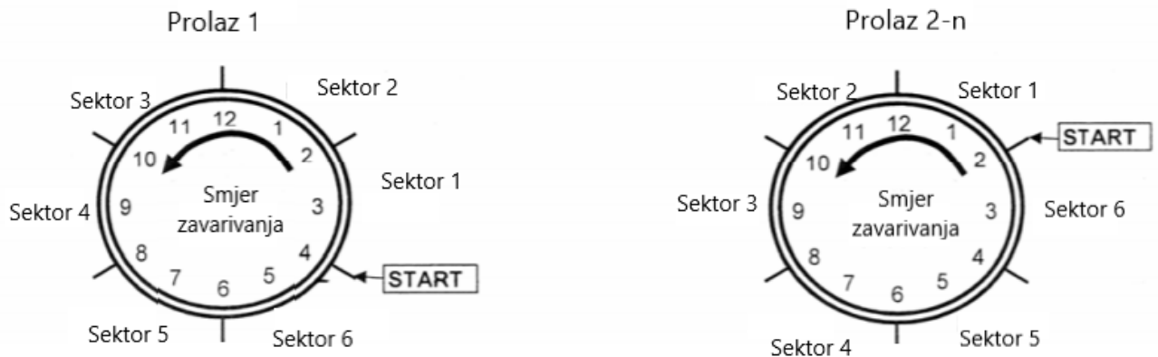
Slika 21: Podjela na sektore kod orbitalnog TIG zavarivanja [20]
