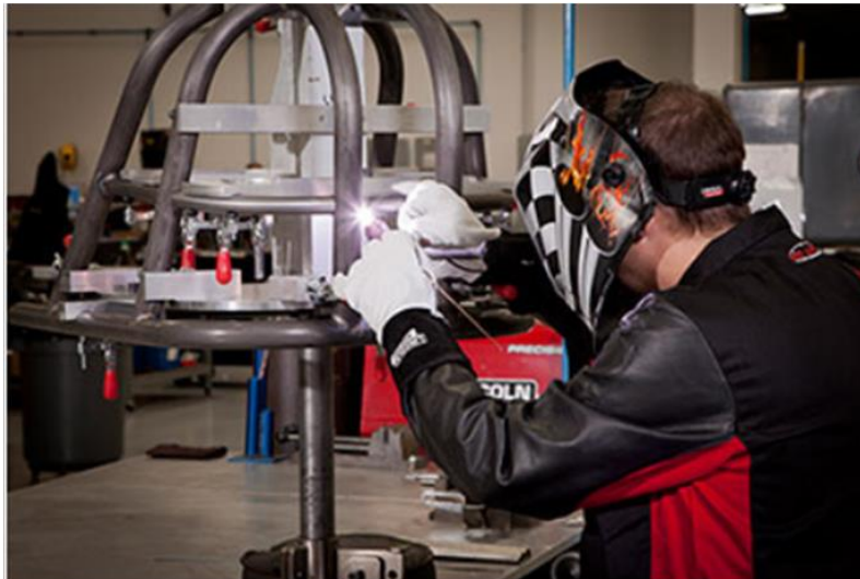
Slika 16: Zavarivanje zaštitnog kaveza trkaćeg automobila [19]
