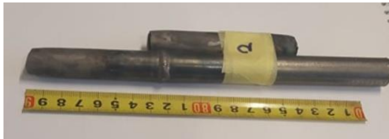
Slika 38: Uzorak B nakon statičkog vlačnog pokusa
