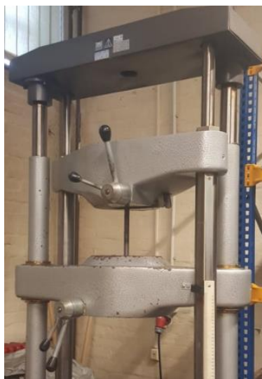
Slika 34: Priprema uzorka na kidalici
