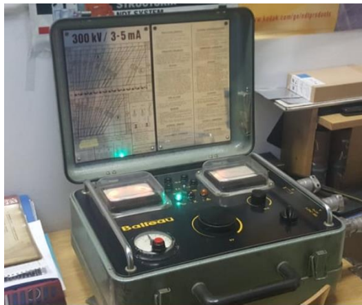
Slika 30: Upravljačka jedinica RTG uređaja- Balteau 300 D
