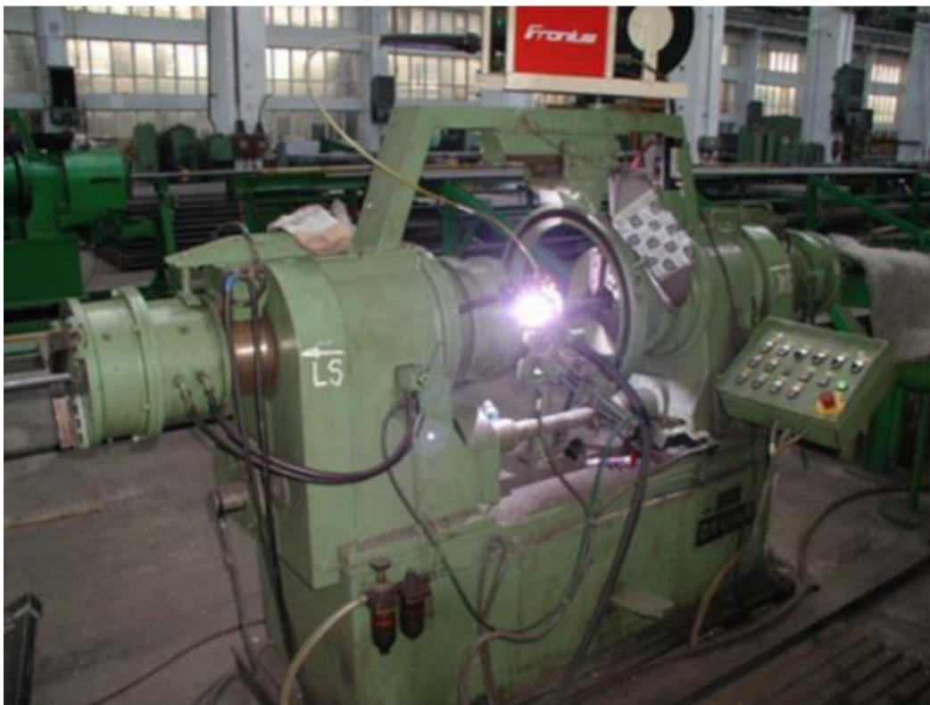
Slika 17: Automatski postupak TIG zavarivanja s okretanjem cijevi [20]
