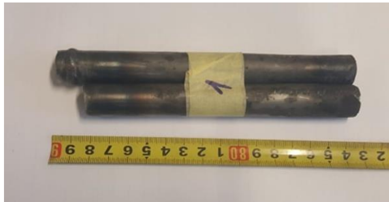
Slika 37: Uzorak A nakon statičnog vlačnog pokusa
