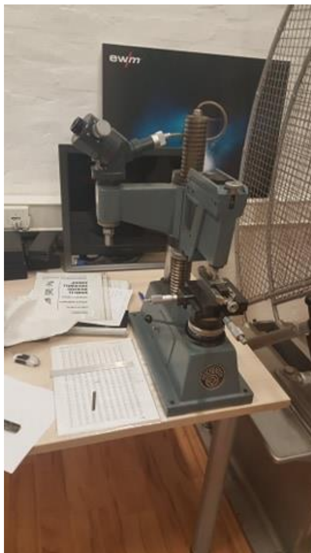
Slika 44: Uređaj za mjerenje tvrdoće po presjeku metodom HV10
