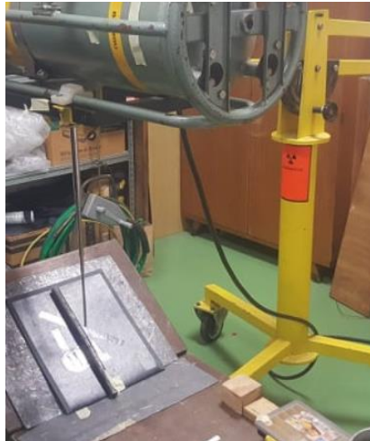
Slika 31: Priprema uzorka za snimanje rendgenom
