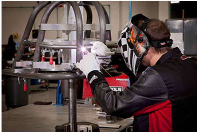
Slika 16: Zavarivanje zaštitnog kaveza trkaćeg automobila [19]
