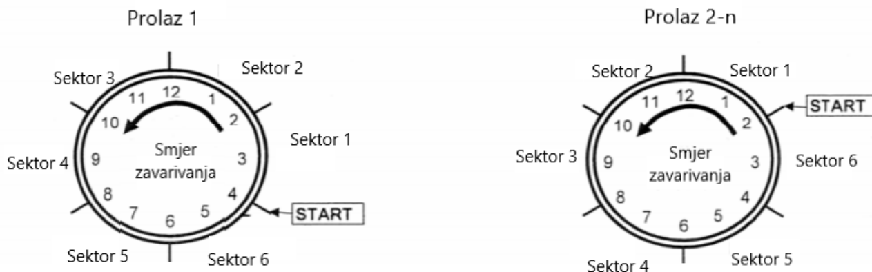
Slika 21: Podjela na sektore kod orbitalnog TIG zavarivanja [20]
