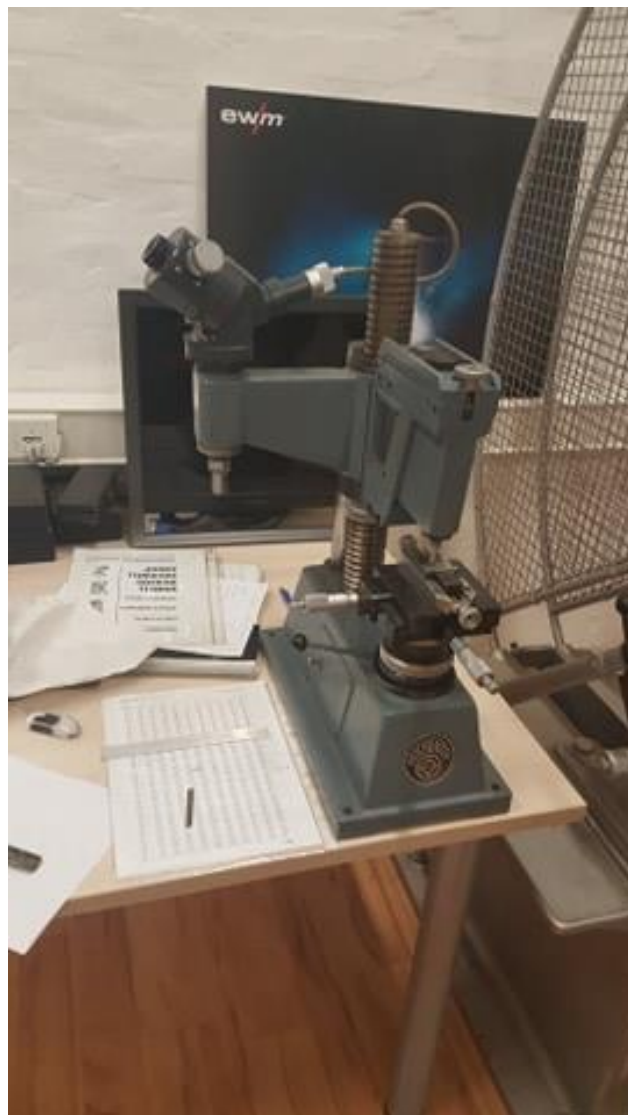
Slika 44: Uređaj za mjerenje tvrdoće po presjeku metodom HV10
