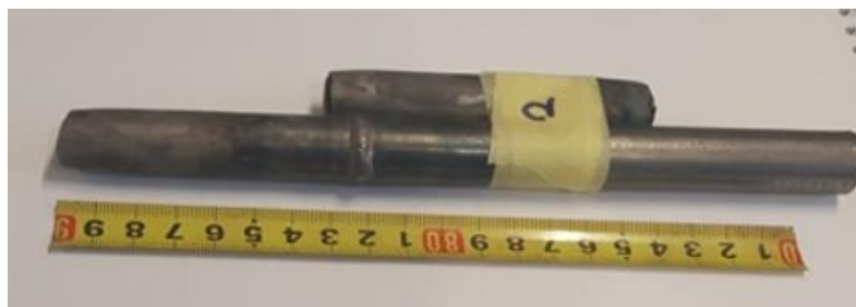
Slika 37: Uzorak A nakon statičnog vlačnog pokusa
