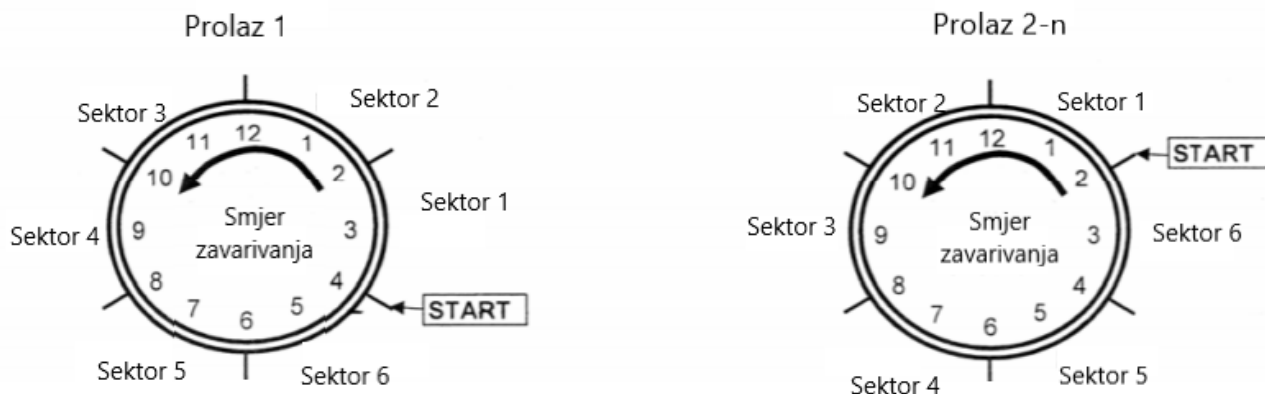
Slika 21: Podjela na sektore kod orbitalnog TIG zavarivanja [20]
