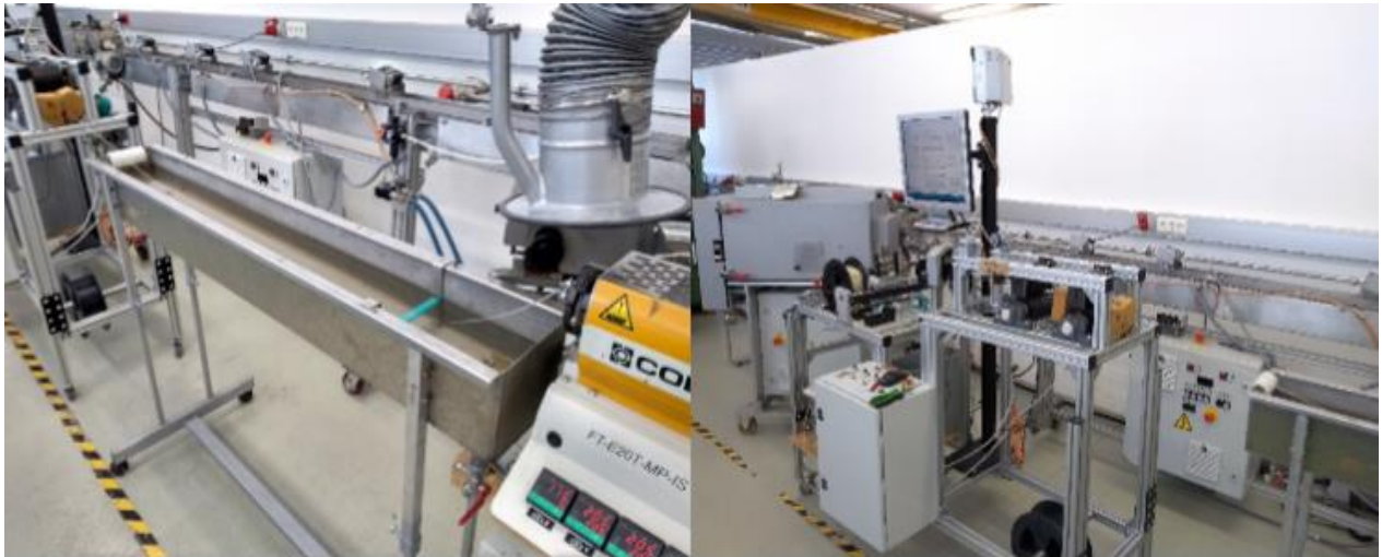
Slika 11: Jedinica za hlađenje i namotavanje filameta
