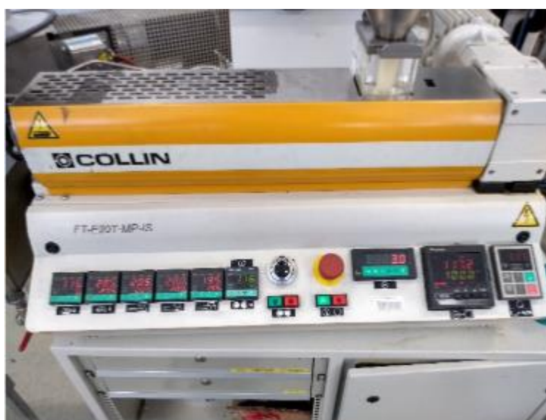
Slika 10: Jednopužni ekstruder korišten u izradi recikliranog filamena
